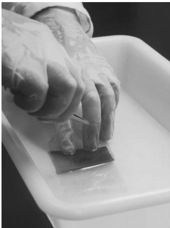
Proceso de separación de la emulsión del soporte de acetato.
