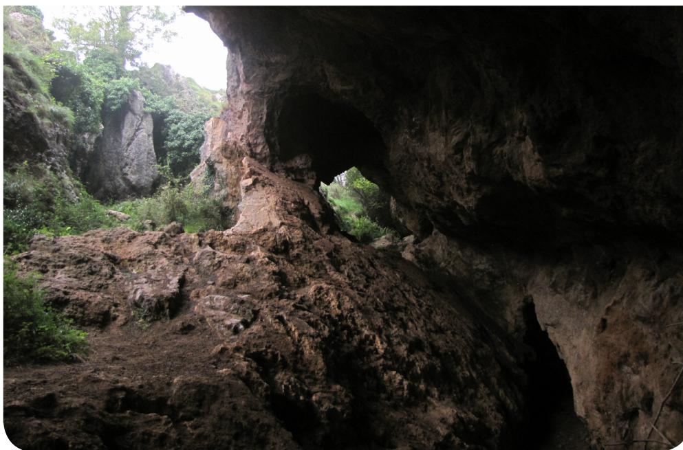
En el interior el vaciado del mineral de hierro es total. Se puede apreciar el sistema de pilares que utilizaron para excavar el mineral.
