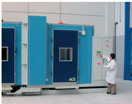
Figura 1: Equipo caja caliente guardada
