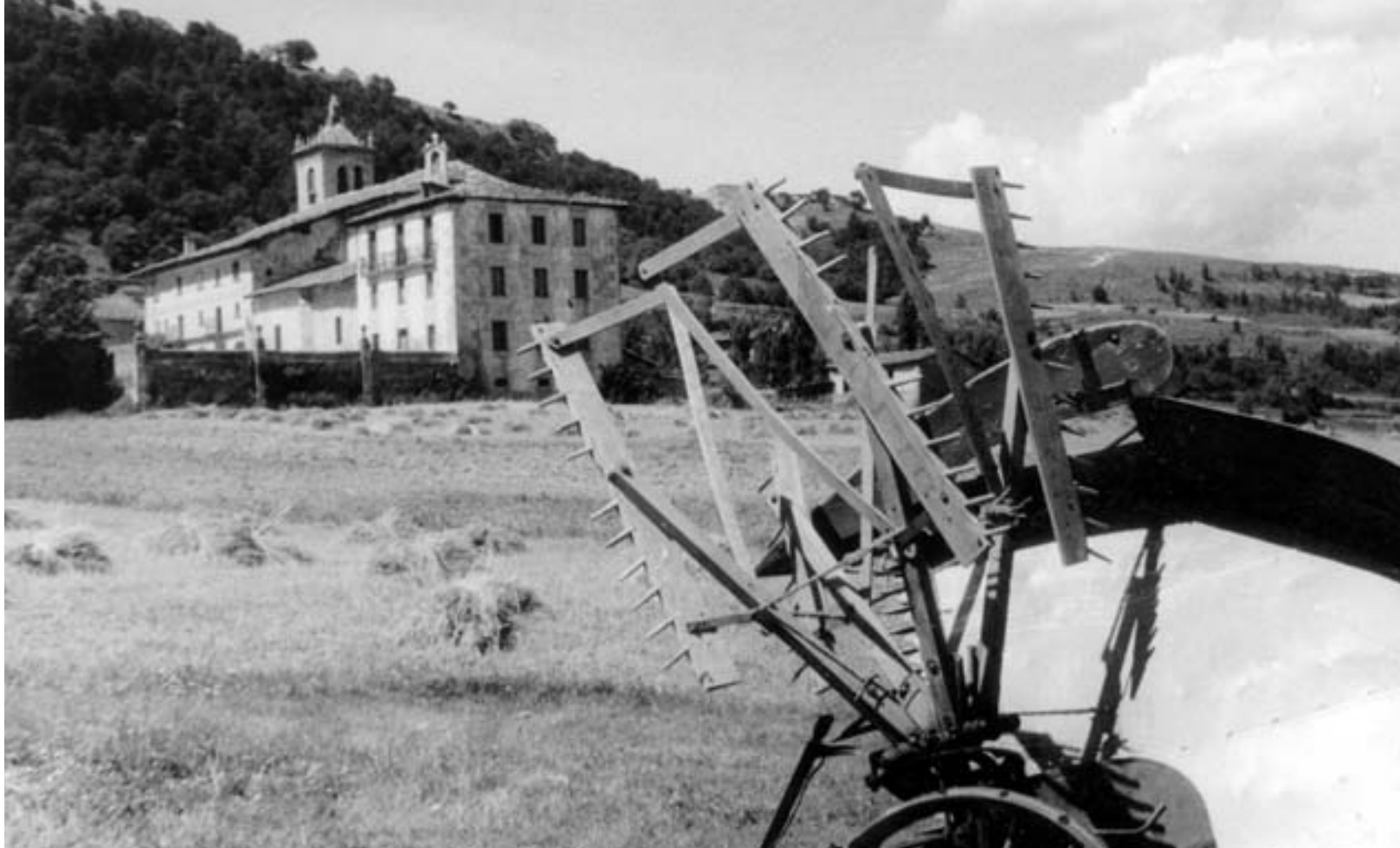
Animalia batek tiratutako sega-makina; horren arrasteluak elkarren segidan mugitzen dira, bere bidetik bikain ordenatutako azaoak utziz. Una segadora tirada por tracción animal, cuyos rastrillos se mueven unos tras otros para ir dejando a su paso ordenadas gavillas.
