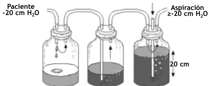
Figura 5. Sistema de tres botellas. El primer frasco hace de recolector, el segundo es el Bülau y el tercero regula la aspiración que se le transmite al paciente, dependiendo de la altura de la varilla sumergida.
