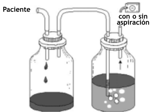
Figura 4. Sistema de dos botellas. Botella recolectora y botella con sello de agua.
