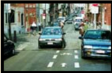
Contrasentido con señalización horizontal ocasional
