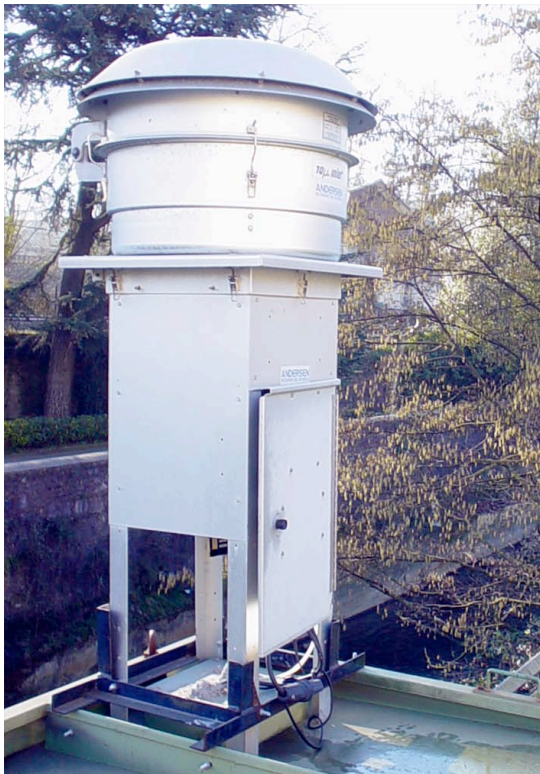
Figura III.15. Aspecto del muestreador de alto volumen Thermo-Andersen empleado en la recolección del material particulado PM10 en la localidad de Beasain y esquema del funcionamiento de dicho muestreador (cf. texto).
