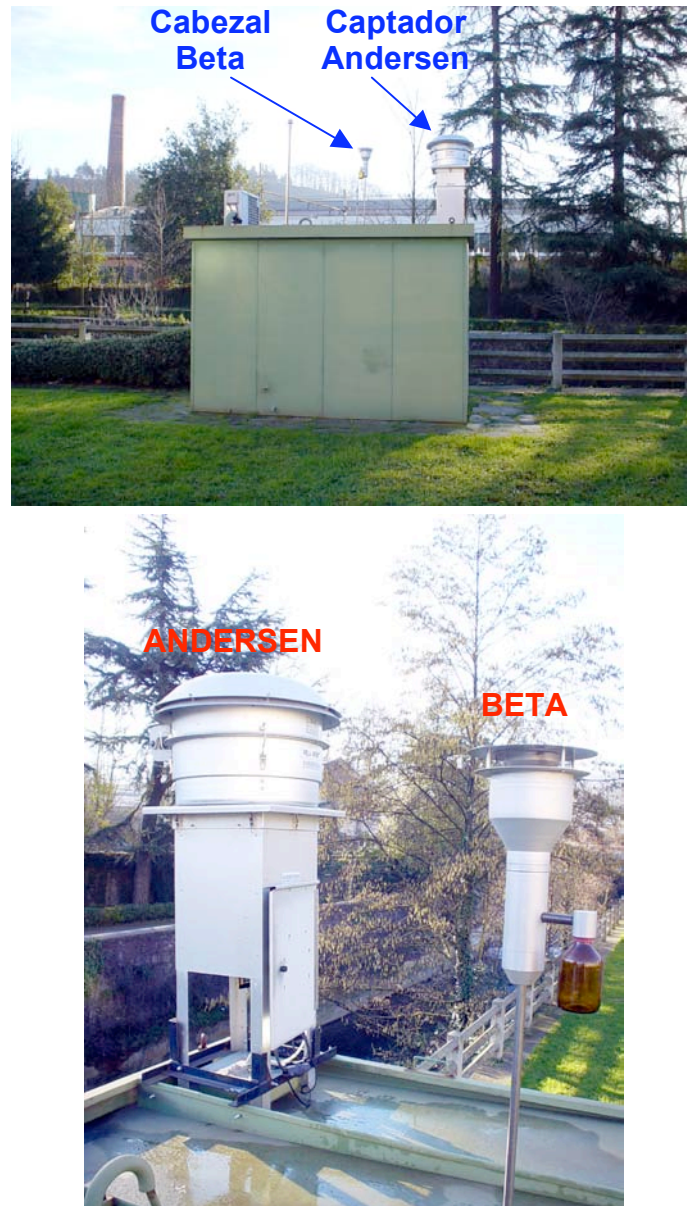
Figura III.13. Aspecto exterior de la cabina utilizada en el muestreo y detalle de los equipos instalados sobre el techo para la medición del PM10: captador gravimétrico Andersen y cabezal del detector automático Beta.
