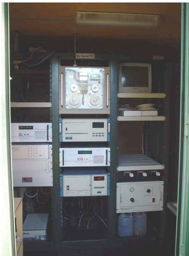
Figura III.14. Aspecto del interior de la cabina utilizada en el muestreo mostrando los equipos de medición automática instalados en la misma. En la parte superior de la columna central se halla el medidor de atenuación de la radiación Beta (cf. texto).
