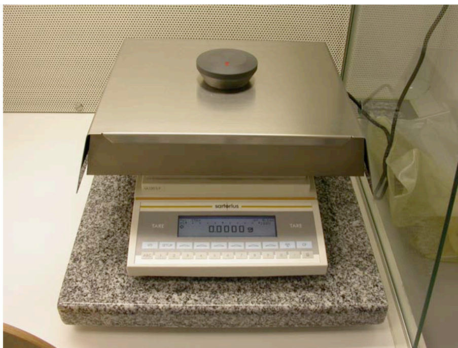
Figura III.16. Aspecto de la balanza de 5 cifras Sartorius utilizada para pesar los filtros estudiados. La balanza se encuentra en una cabina de flujo laminar horizontal dentro de un laboratorio presurizado con temperatura y humedad constantes (sala blanca).
