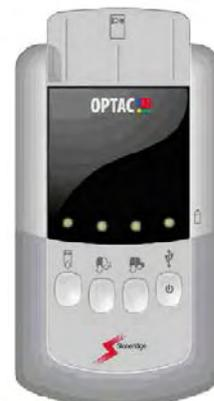
obstante dispone de un conector USB con el que se puede conectar a un ordenador para recuperar los archivos de descarga para su custodia o gestión. Es capaz de almacenar 500 tarjetas de conductor y 80 descargas trimestrales de tacógrafo.
