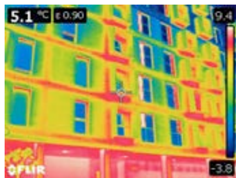
Inspecciones complementarias de termografía infrarroja de fachadas y ensayo de estanqueidad al aire, Blowerdoor.
