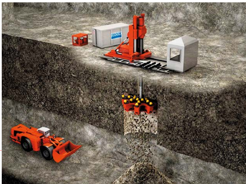
«Raise boring» sistemaren funtzionamendu eskema.
