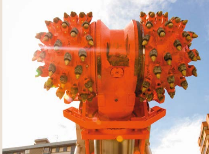
MT520 lubaki makinaren mozketarako buruak.
