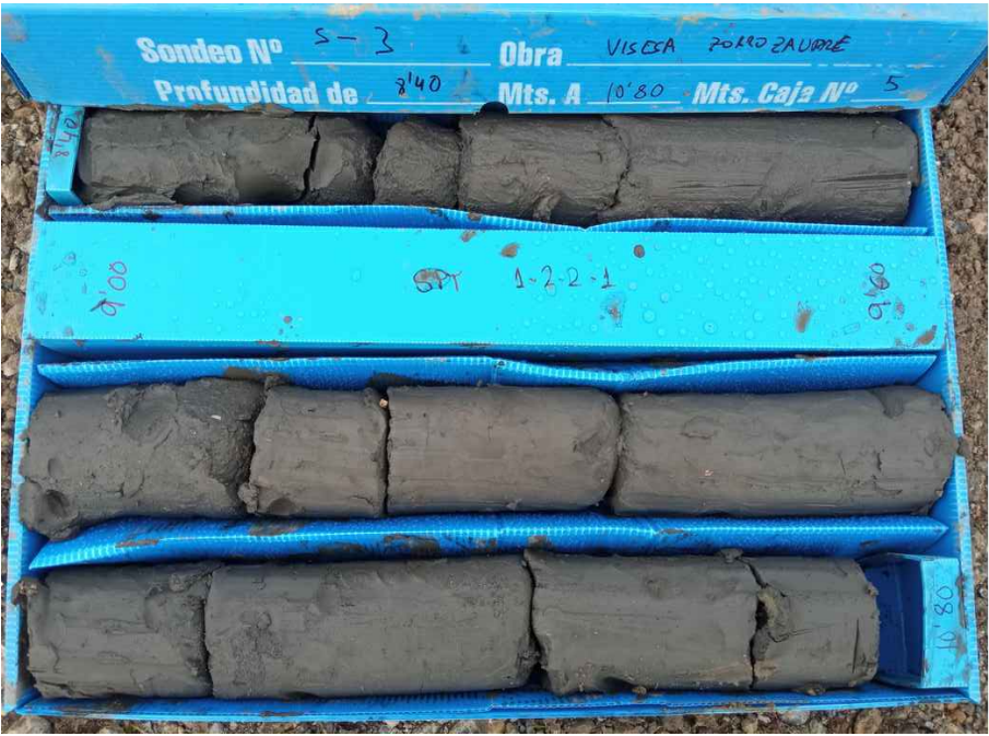
Caja 5 : Profundidad de 8.40-10.80 m.
