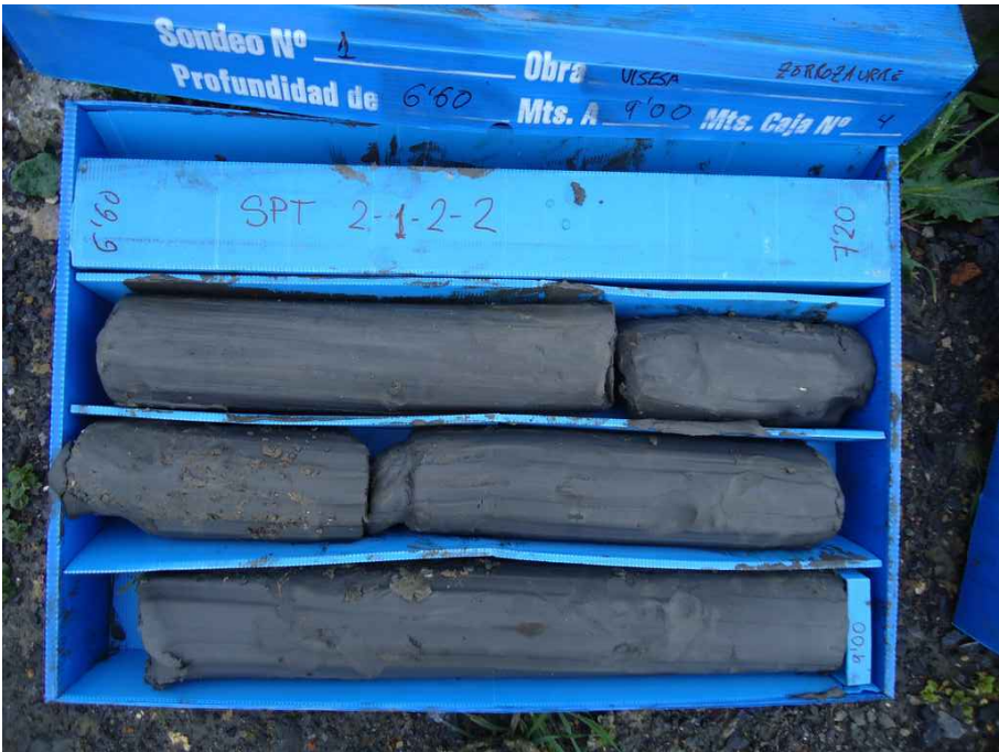
Caja 4 : Profundidad de 6.60-9.00 m.
