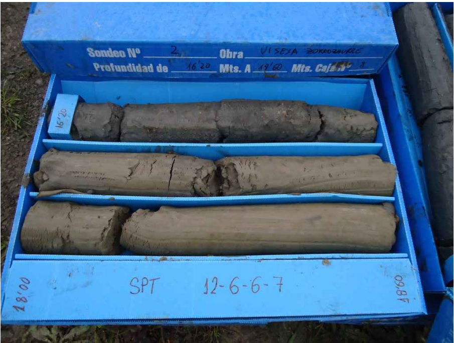
Caja 8 : Profundidad de 16.20-18.60 m.
