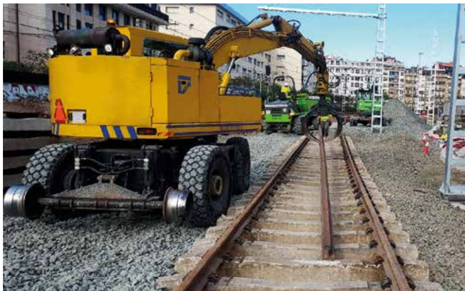
5. argazkia. Altxatze-elementuak, errailaren pintza.
