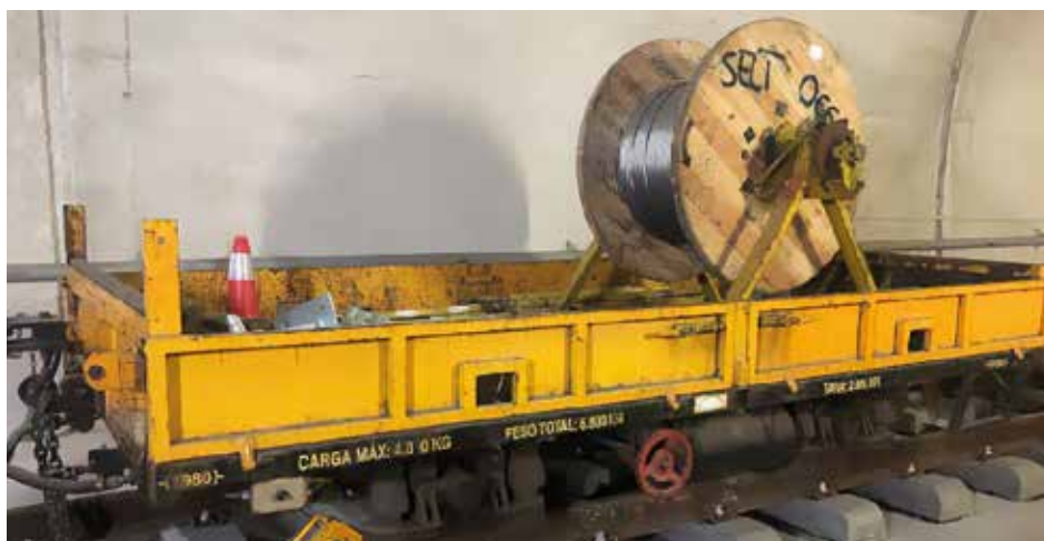
Fotografía 137. Plataforma con portabobinas.
