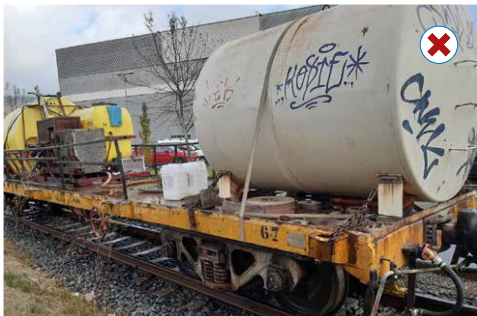
Fotografía 47. Riesgo de caída de objetos. Deficiente flejado, materiales sueltos.
