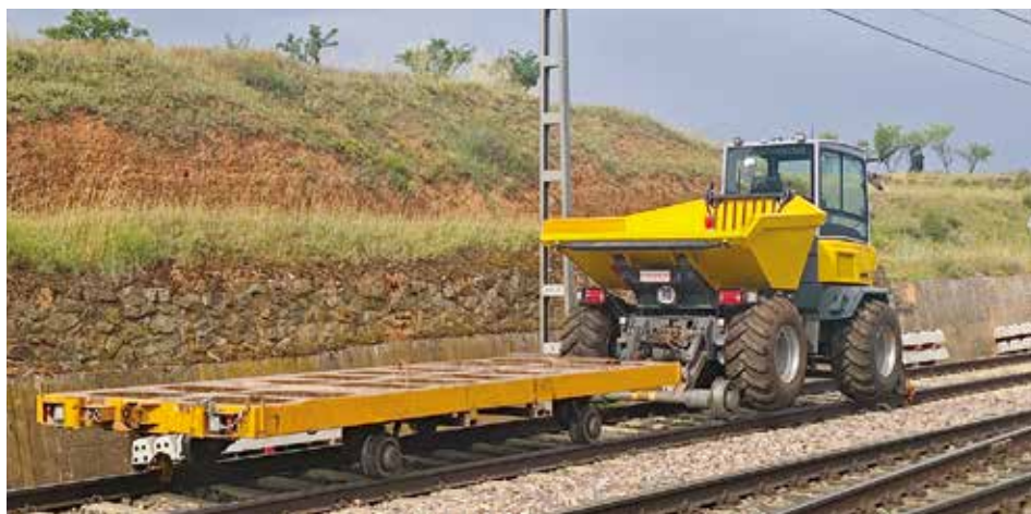
Fotografía 136. Plataforma de vía.
