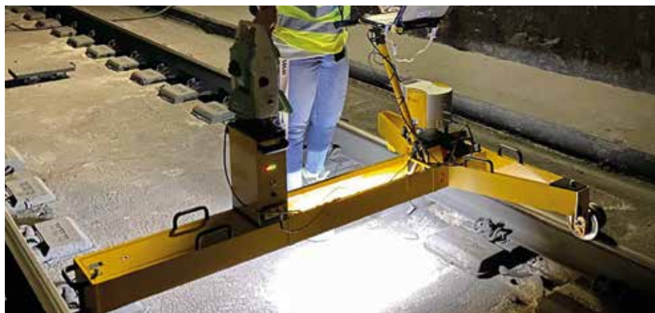
Fotografía 122. Carros de auscultación. Sistemas de medición para topografía ferroviaria.
