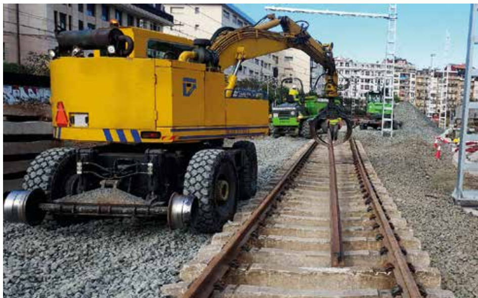
Fotografía 5. Elemento de izado, pinza de carril.
