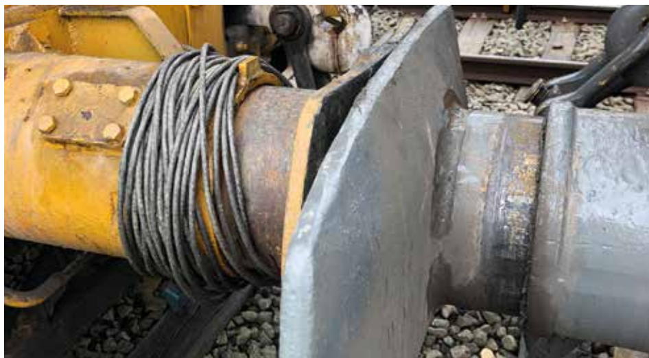
Fotografía 22. Zona de riesgo de atrapamiento entre trenes de trabajo.
