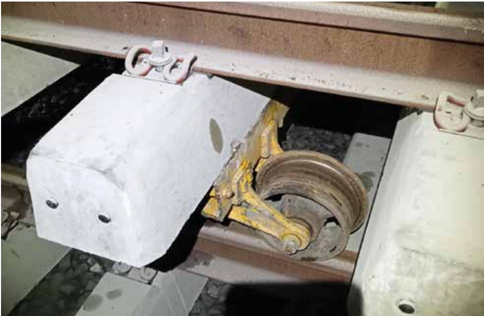
Fotografía 21. Diploris que se utilizan de manera auxiliar, no circulando libremente por la vía.
