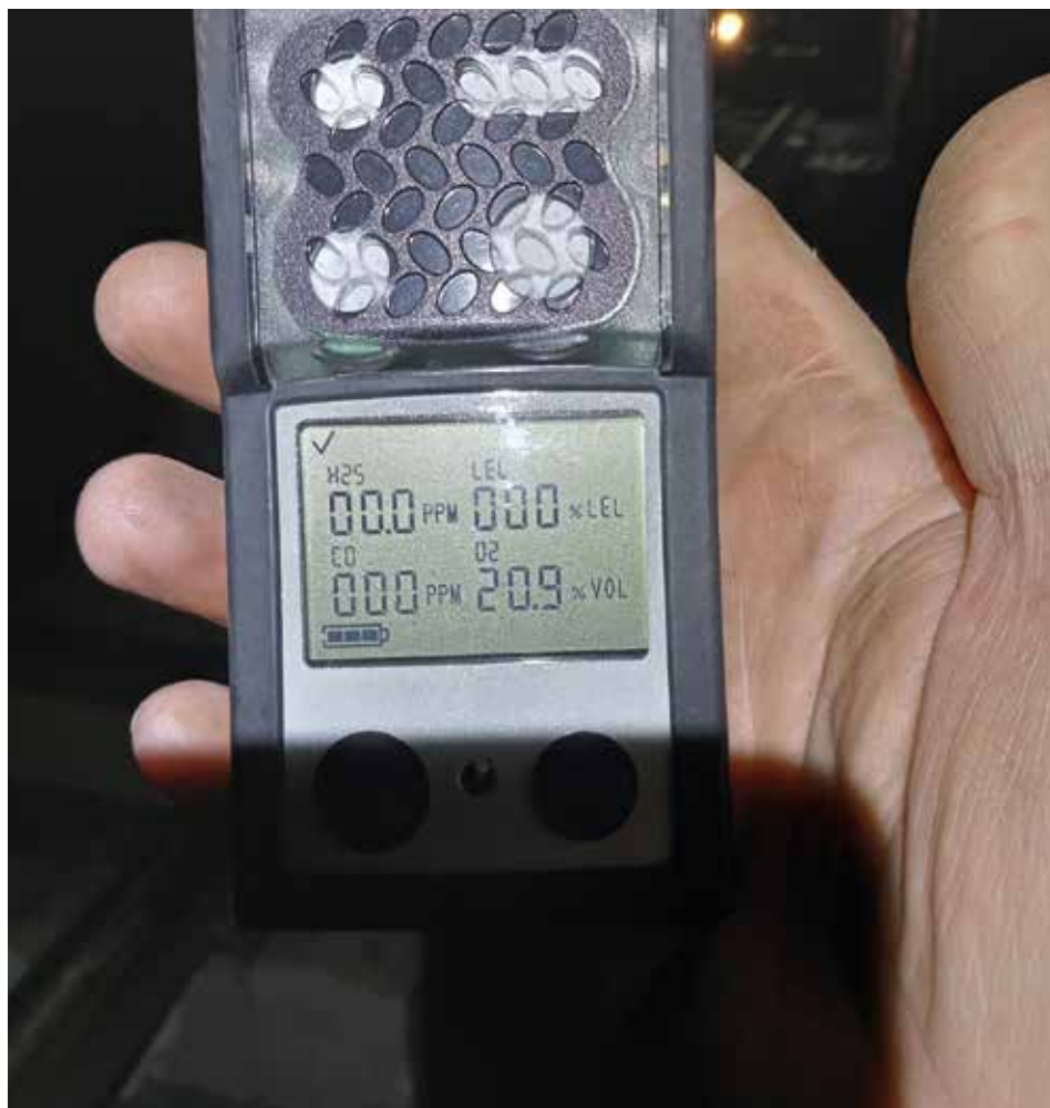
Fotografía 160. Equipo de medida de gases.
