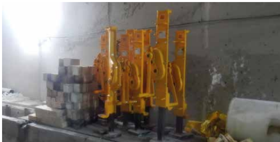
Fotografía 133. Gatos de vía.
