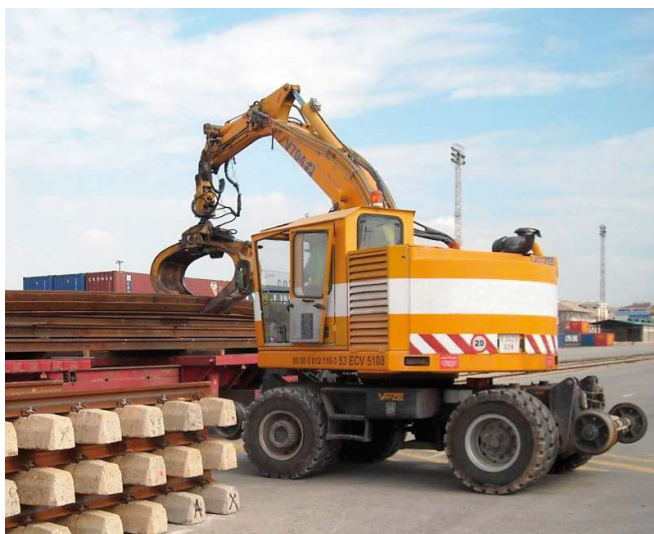
Fotografía 12 Transporte y descarga de carriles
