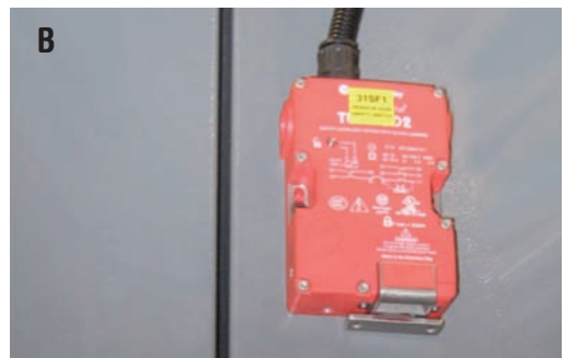
35 A eta B argazkiak: makinak EE markaketa dauka, aldatutako segurtasun-gailua du eta babesgarriaren gainean dago jarrita zubia erosoago egin ahal izateko.
