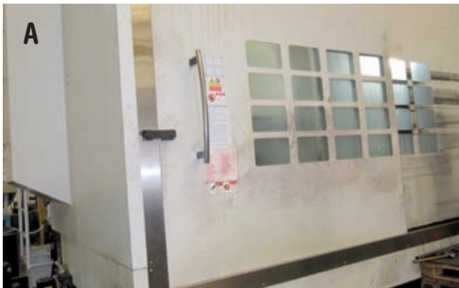
34 A eta B argazkiak: babesgarri mugigarriak atxikimendua eta blokeoa ditu. Eskuzko blokeoa ez da babesgarrizat hartuko.
