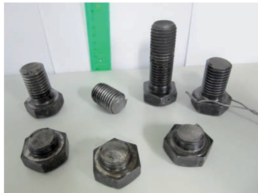
10. argazkia: makinako zenbait torloju zerbitzuan hautsi dira, artatu ez direlako edo behar bezala artatu ez direlako.
