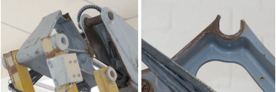
11 A eta B argazkiak: jasotzeko plataforma zerbitzuan hautsi da, behar beste artatu ez delako. Erabilera-eskuliburuan adierazi beharko da zer atal artatu beharko diren.
