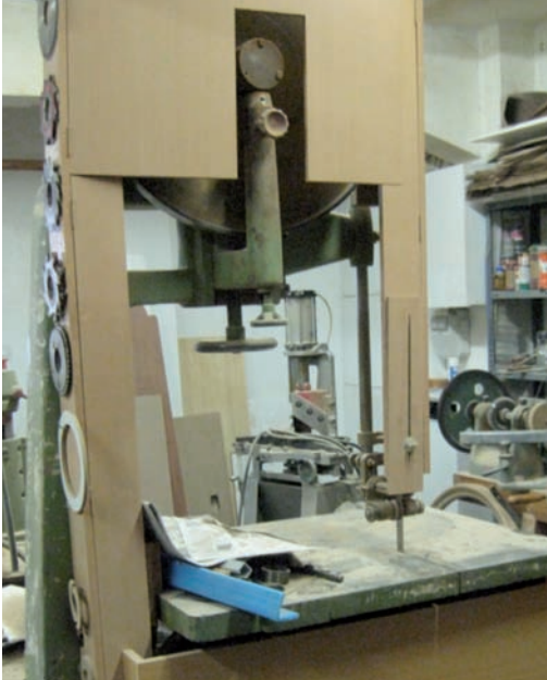
28. argazkia: zerrak bertan egindako babesgarriak daramatza. Babesgarriak segurtasun-elementuak izango dira, eta euren markaketa edukiko dute.
