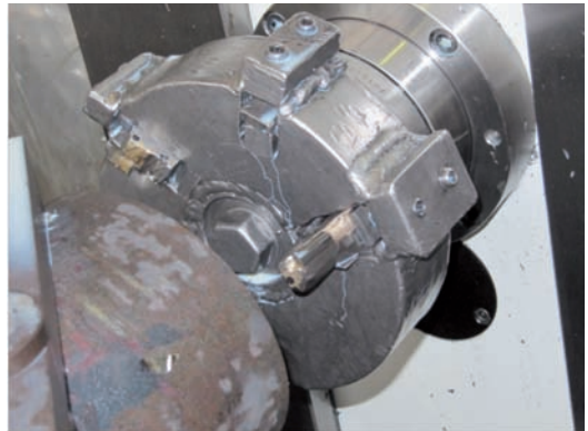
13. argazkia: beste plater honetako atzaparrak ere aldatu egin dituztenez, pieza proiektatzeko edo platera bera hausteko arriskua areagotu egin da, landu beharreko piezen arabera dimentsioko platera ez erabiltzeagatik.
