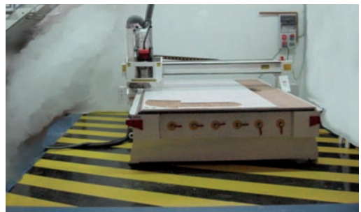
43 A, B eta C argazkiak: eskuliburuaren irudiak prebenitzeko orduan zoruan marra horia egin behar dela adierazi arren, hobe izango da makinako segurtasun-sistemak abian edukitzea. Seinaleek bakarrik ez dituzte langileak makinako arriskuetatik babestuko.
