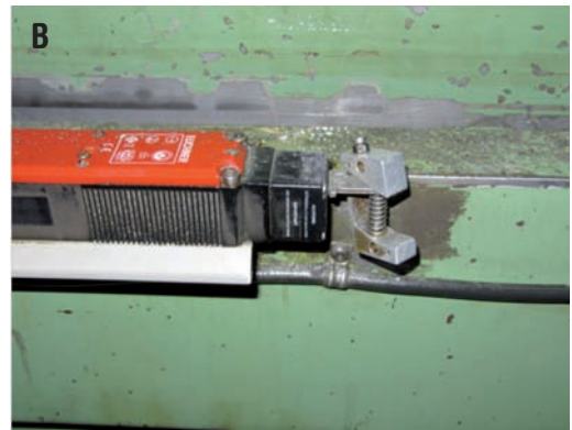
23 A eta B argazkiak: makinan, gailuari egin diote zubia, eta xehetasunak ikusten dira.
