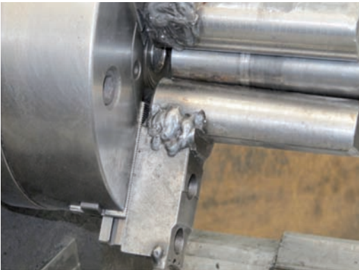
12. argazkia: platereko atzaparrei luzapenak gehitu dizkiote, makinagileak erabilerarako mugetan adierazitakoa ez beste tamaina bateko piezei heldu ahal izateko. Hori dela eta, makina aldatu eta arrisku gehigarriak sortuko dira.
