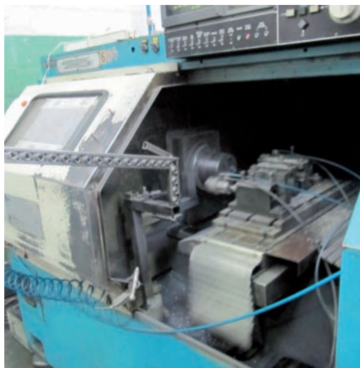
16. argazkia: makinari babesgarria kendu diote elika-gailua jartzeko, eta, gainera, bertan ekoitzi dute.
