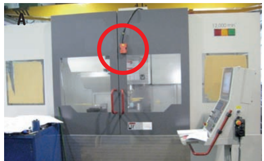
34 A eta B argazkiak: babesgarri mugigarriak atxikimendua eta blokeoa ditu. Eskuzko blokeoa ez da babesgarrizat hartuko.
