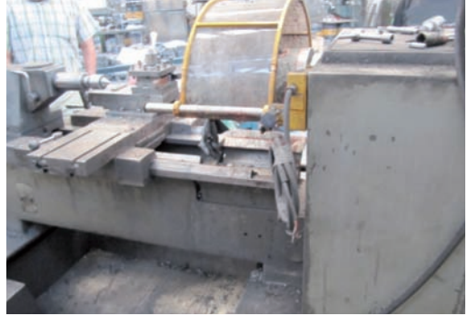
25. argazkia: babesgarri mugigarrii kontroleko kableak ebaki dizkiote
