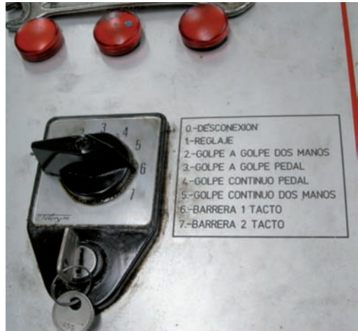
6. argazkia: aginte-hautagailu honetan, ukimen bateko barrera eta 2 ukimeneko barrera daude ikusgai. Beraz, barrera fotoelektrikoa edo immateriala ez da langileentzako babes moduan erabiliko, makinari eragiteko gailu moduan baizik. Modu horiek araudian bertan azaltzen badira ere, hobe izango da ez erabiltzea. Beharrezkoa izanez gero, langileek erabiltzeko prestakuntza berezia jaso beharko dute, eta segurtasun-neurri gehigarriak ezarri beharko dira.
