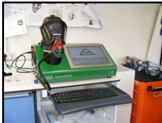
ERako maskararen funtzionamendua eta estankotasuna ikuskatzea
