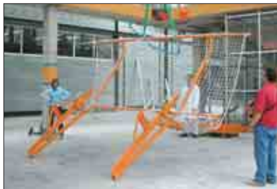
Eslingas con una separación entre sí de 1 metro
