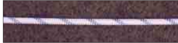
Cuerda trenzada (ventaja adicional antigiro en el montaje).
