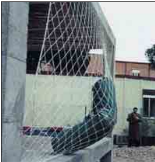
Retención simulador humano por la red.
