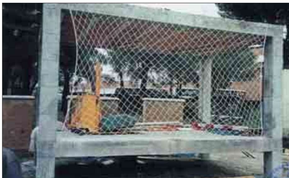
CSIC. Simulador de ensayos Ensayo de red de protección vertical.
