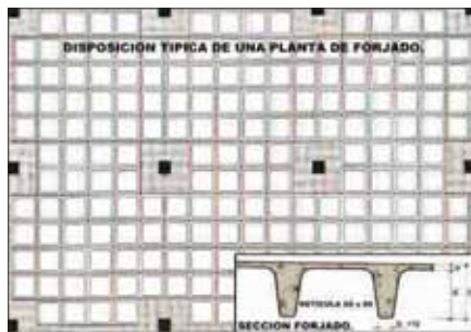
Disposición típica de una planta de forjado
