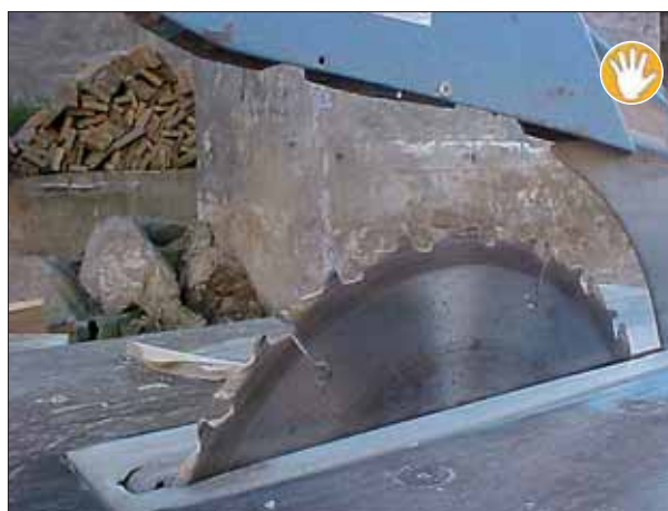
Detalle de dentado de disco sierra circular
