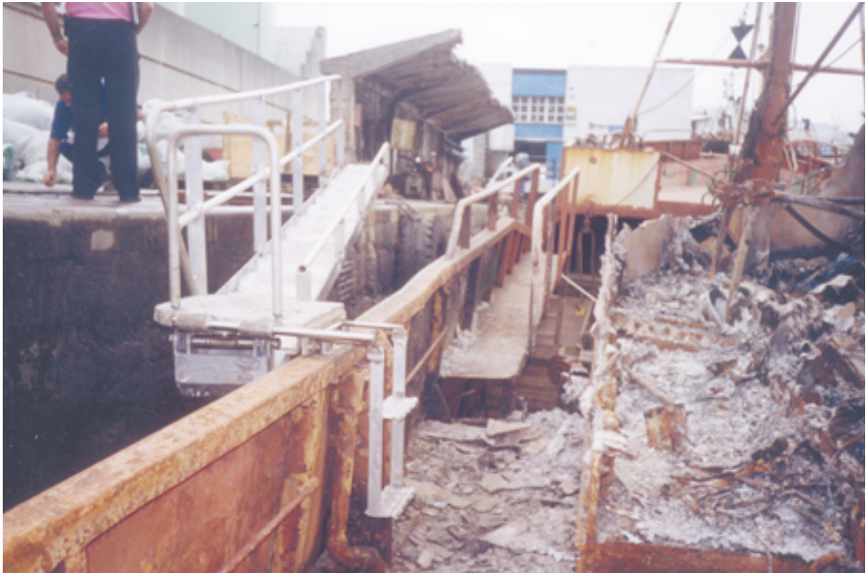
Detalle de la parte fija instalada en la regala del buque de pesca.
