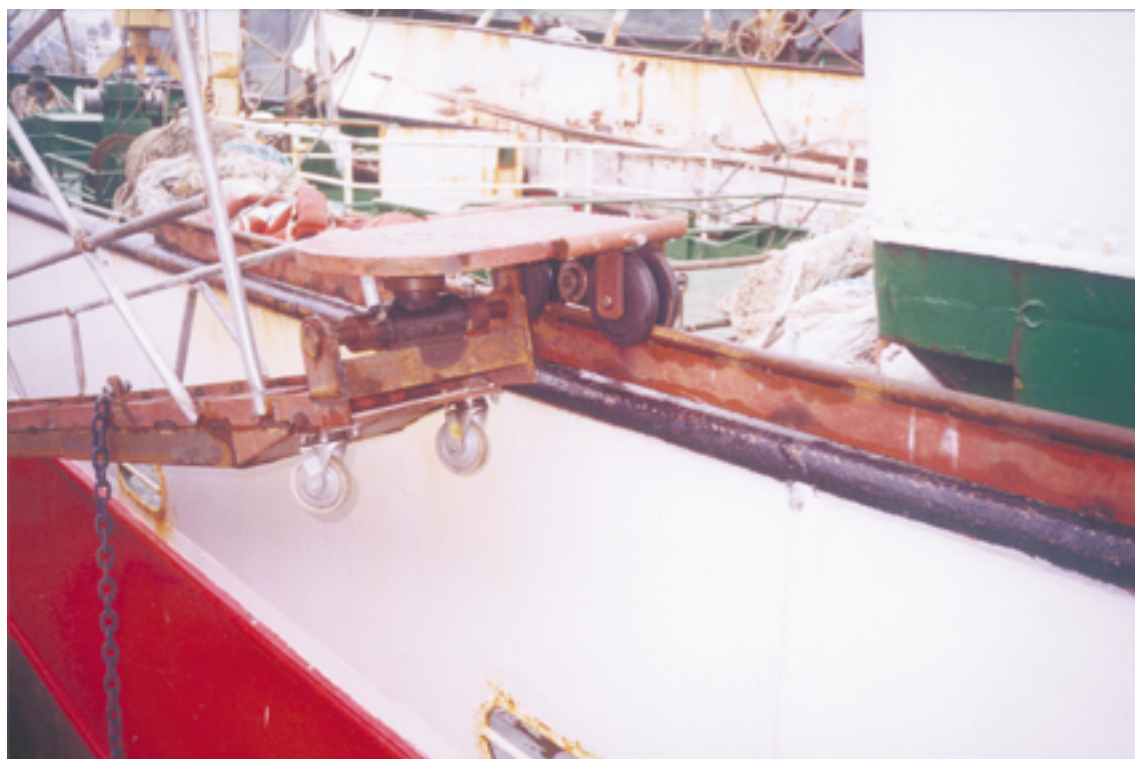
Detalle de la parte superior de la pasarela, que va instalada en la regala del buque y en la que se ve el camino de rodadura.
