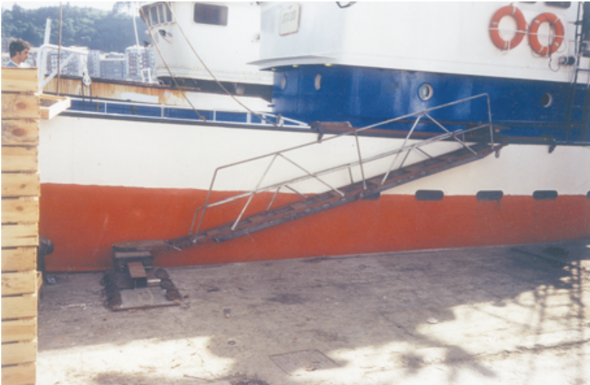
Detalle de la sujeción al muelle y vista en alzado de la pasarela de acceso.
