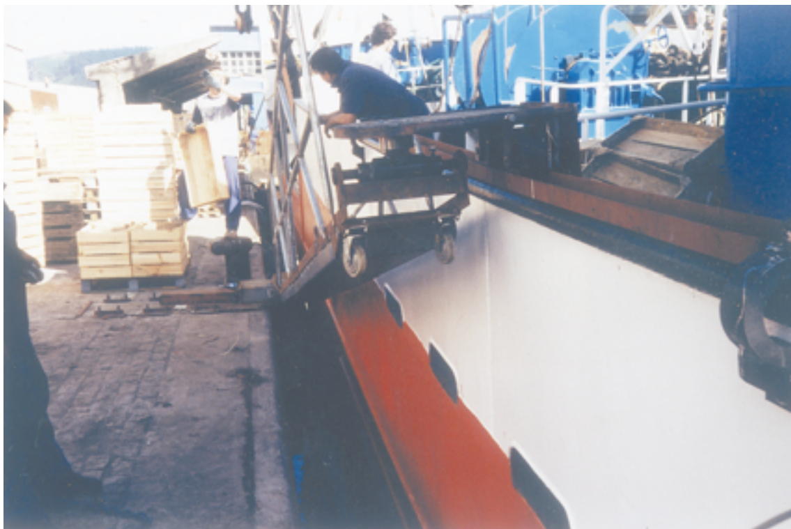
Detalle de la sujeción al muelle así como el camino de rodadura en la regala del buque de pesca.
