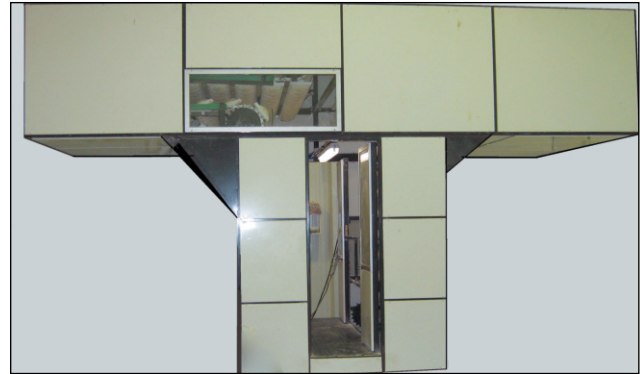
Figura 16.- Cámara de fermentación de volteo o dinámica
