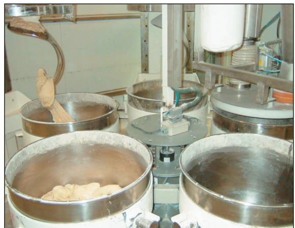
Bajada de artesa en amasado. El carrusel gira en el sentido de las agujas del reloj
