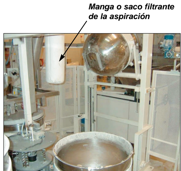
Recogida de artesa y proceso de volcado a tolva de divisora
