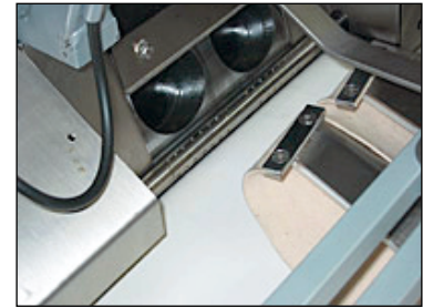
Figura 12.- Detalle de divisora automática
