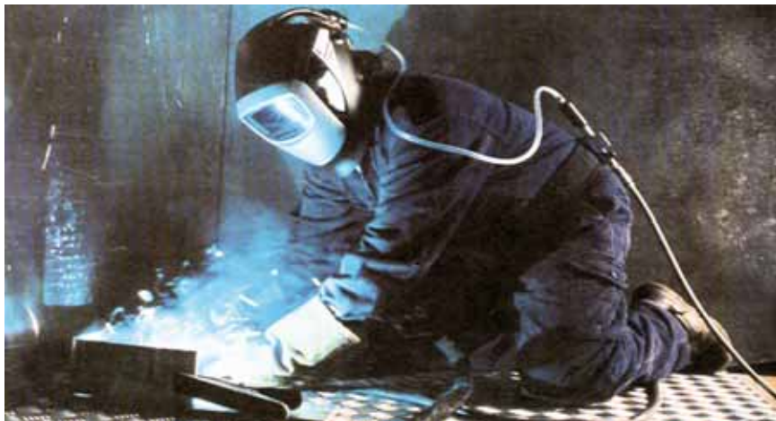
Aire lineaz hornitutako soldadura pantaila.
