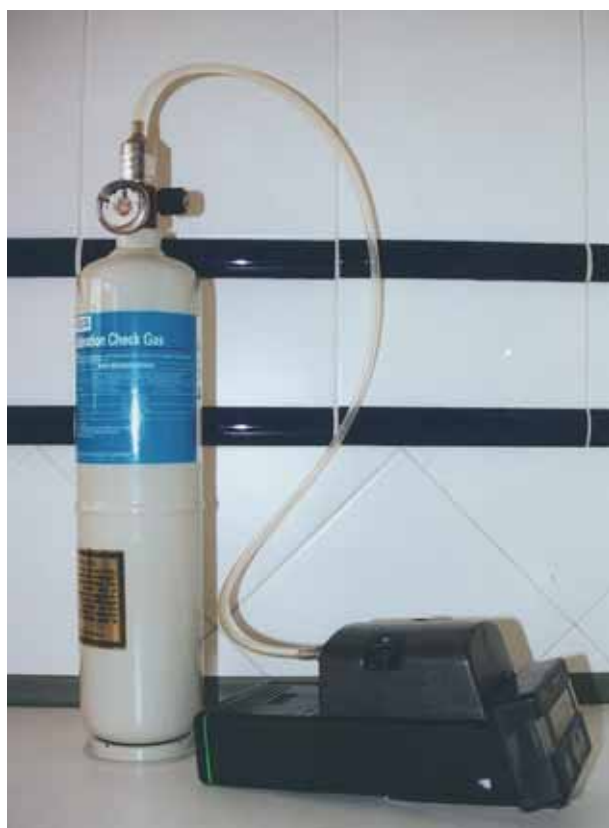
Kalibrazio ekipoa, gas botila detektagailuaren aspirazio ponpara zuzenean akoplatuta duela
