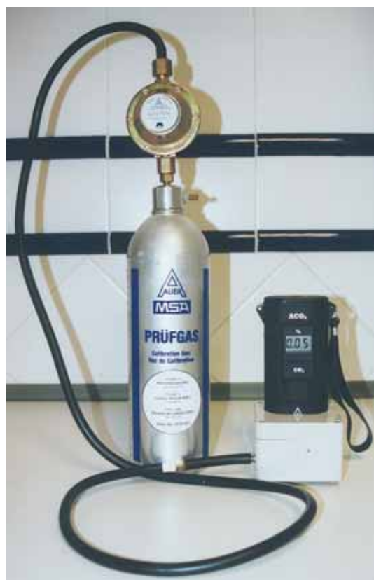
Kalibrazio ekipoa, detektagailuaren sentsoarea kapsulatuta duela
