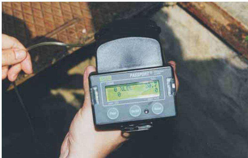
Aldi berean leherkortasun indizea eta oxigeno, karbono monoxido eta hidrogeno sulfuro kantitateak neurtzea
