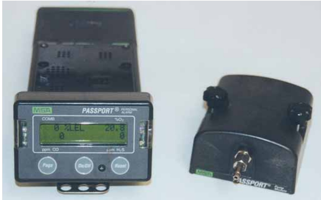
Aspirazio ponpa, etengabeko detektagailuan akoplagarria
