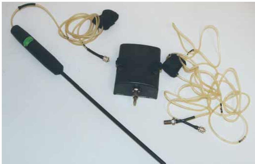
Zunda eta laginketa lineak aspirazio ponpan akoplagarriak
