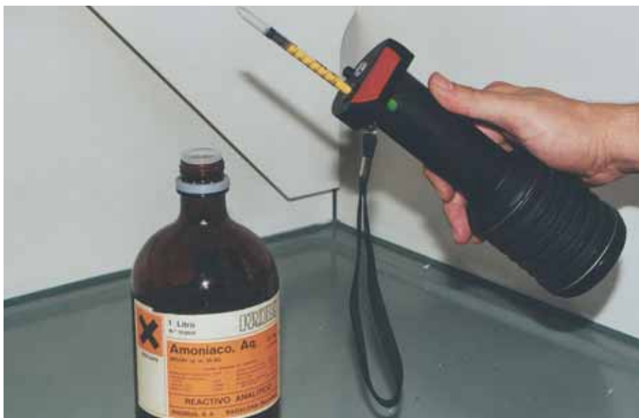
Neurketa amoniakoarentzako hodi detektatzaile espezifiko kuantitatiboaren bidez
