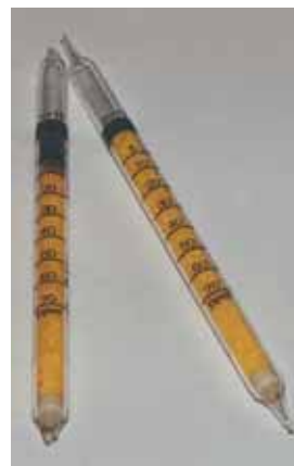
Neurketa amoniakoarentzako hodi detektatzaile espezifiko kuantitatiboaren bidez
