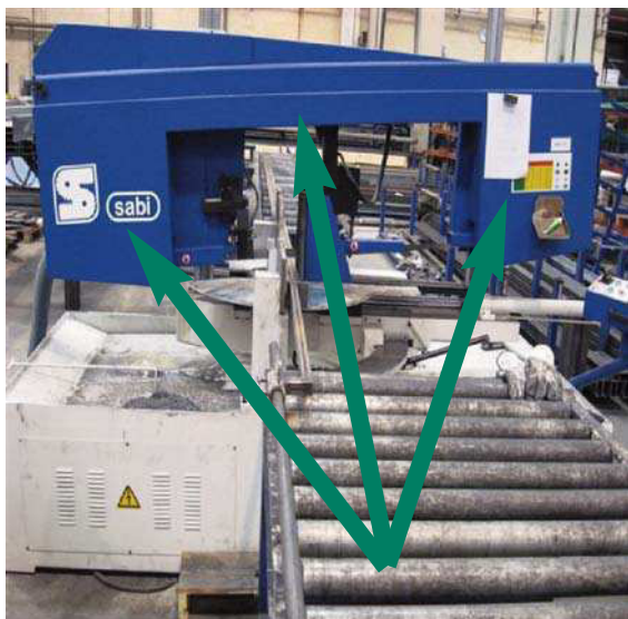
Zinta-zerra, babesa itxita: makinak funtziona dezake.
