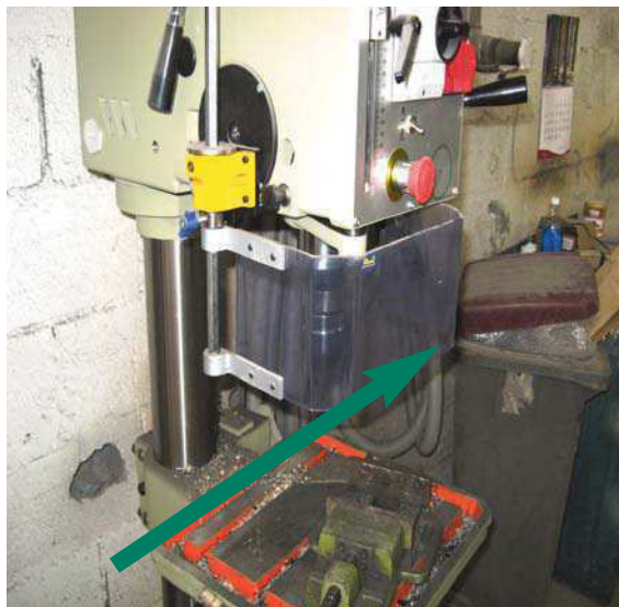
Babesa (pantaila) itxita: makinak funtziona dezake “abiarazteko botoia” aktibatzen bada.
