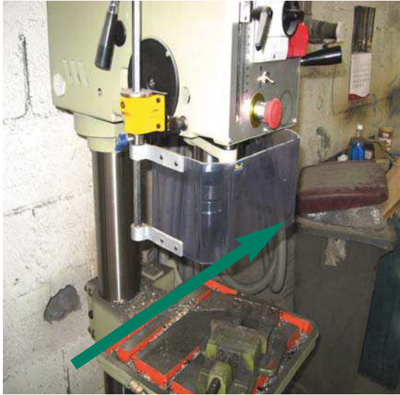
Resguardo (pantalla) cerrado: la máquina puede funcionar si se activa la “puesta en marcha”
