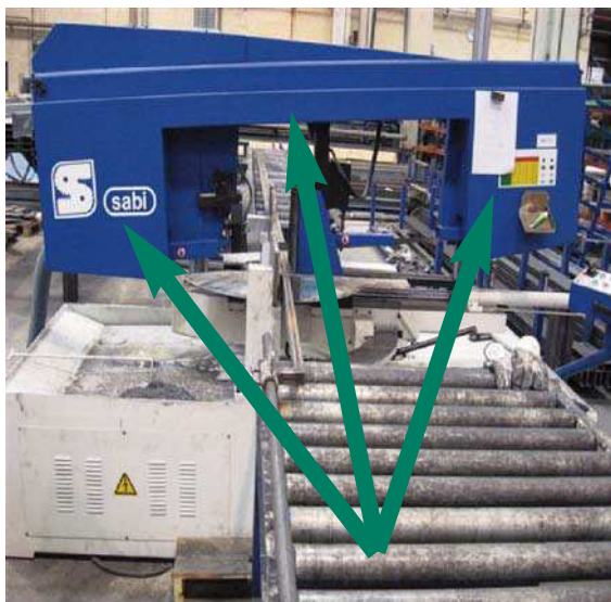
Sierra de cinta con protección en posición de cerrada: la máquina puede funcionar
