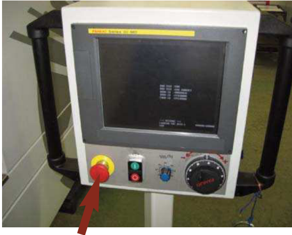
Parada de emergencia "tipo seta" ubicada en el panel de mando
