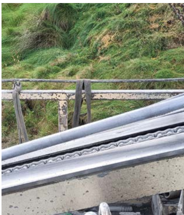
Altuerako erorketen aurkako ainguraketa-gailuak falta dira
