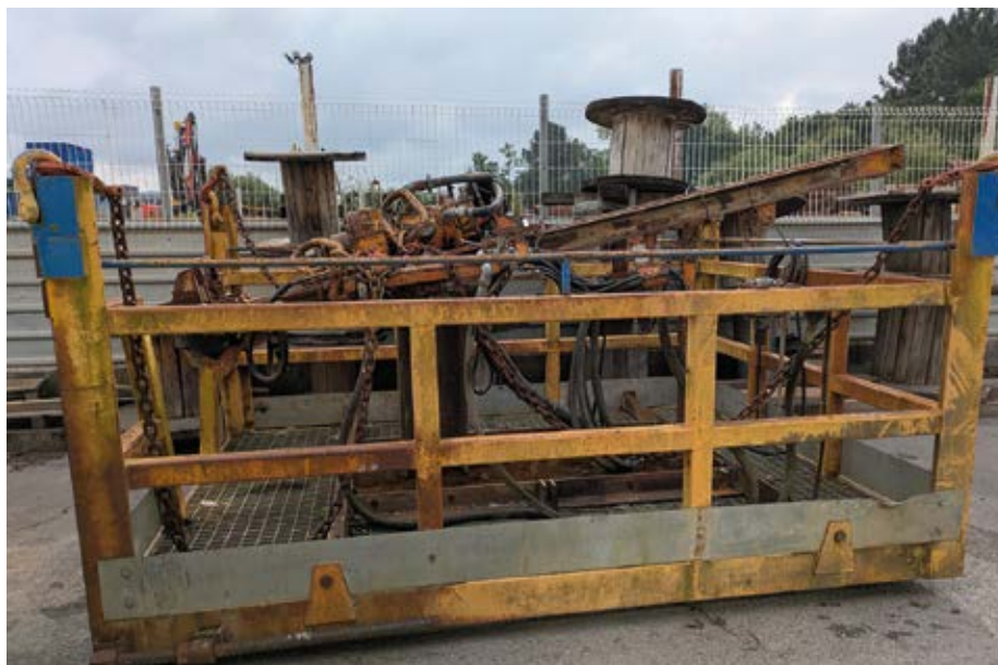
Cesta deteriorada agravada por almacenamiento a la intemperie.
