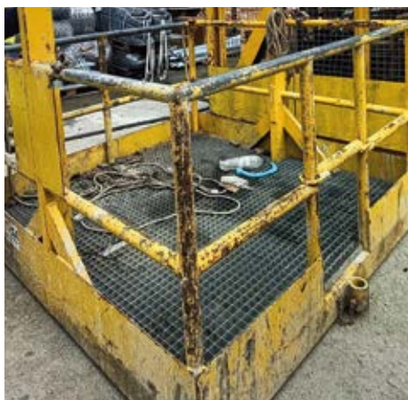
Borde inferior externo de cesta sin espacio libre mínimo para los pies para evitar riesgo atrapamiento.
