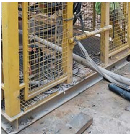
Borde inferior externo de cesta sin espacio libre mínimo para los pies para evitar riesgo atrapamiento.
