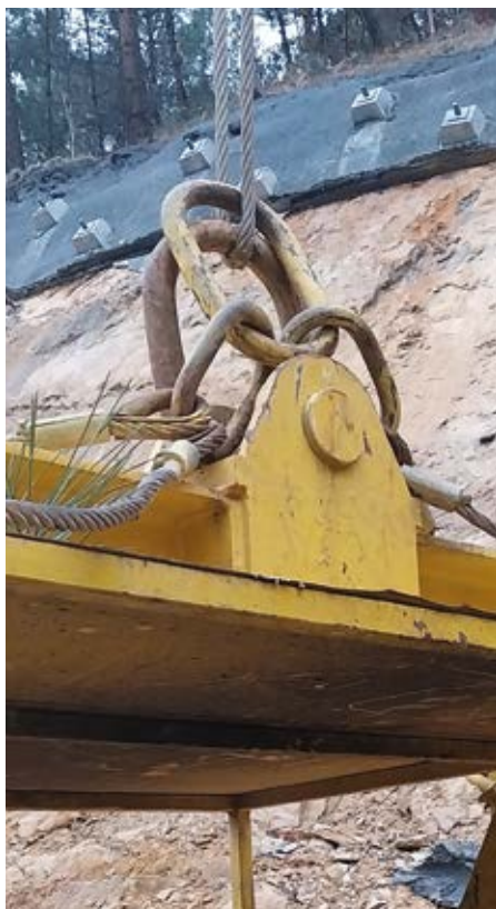
Unión a gancho sin duplicar el elemento crítico (cadena / cable)
