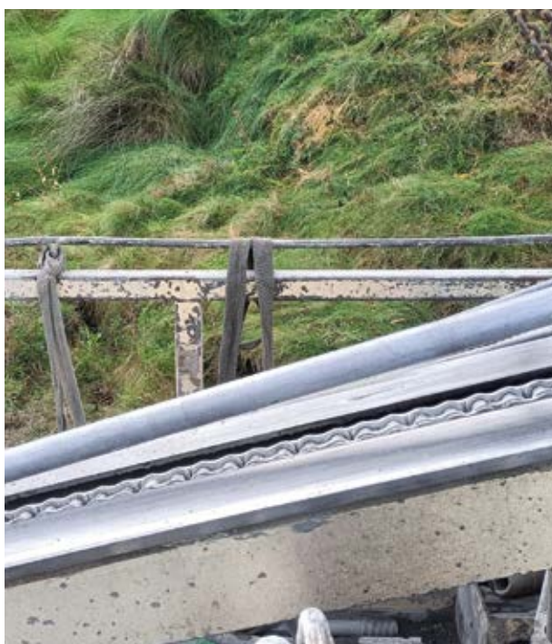
Faltan dispositivos anclaje contra caídas en altura.
