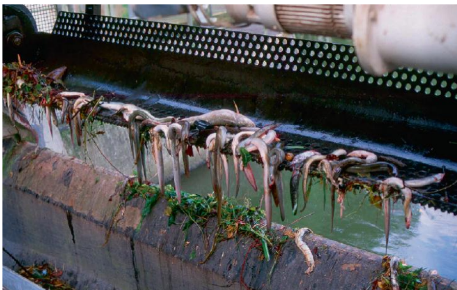
Figura C.2. Anguilas recogidas por el peine o quita-hojas de rejilla de una central hidroeléctrica en el río Fulda, Alemania (foto: Adam B.).
