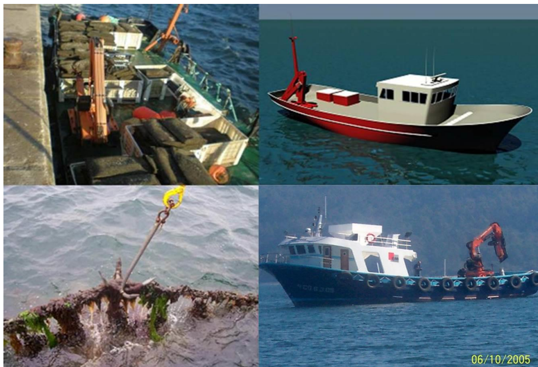
Figura 15. De izquierda a derecha y de arriba abajo, (i) detalle en planta de cubierta de barco para operaciones de longline ; (ii) infografía de barco típico del sector mejillonero; (iii) gancho para izados de líneas madre; (iv) barco típico para operaciones de moluscos.
