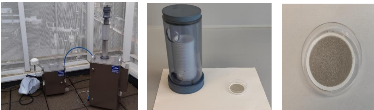
10. irudia: Osasun Zentroko (Eibar) Derenda ekipamendua, iragazkien euskarria eta partikulak lagintzeko iragazkia.
