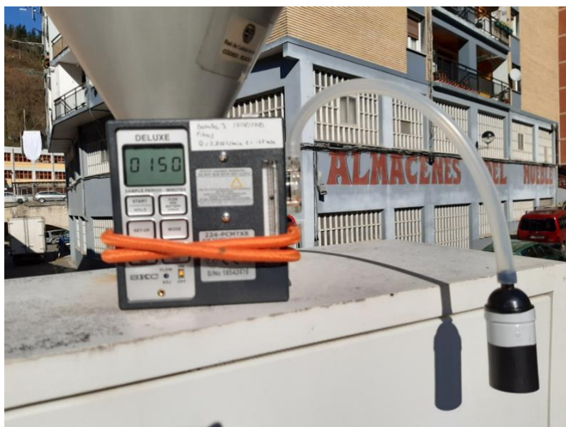
14. irudia: Laginketa-ponpa eta zuntzetarako iragazkiaren prestaketa.
