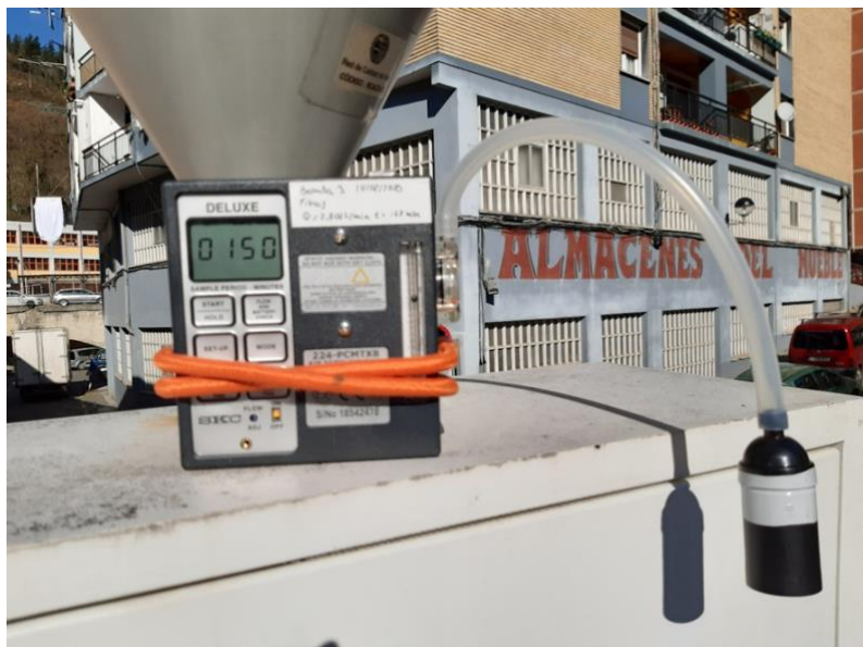
Figura 14: Bomba de muestreo y preparativa de filtro para fibras.
