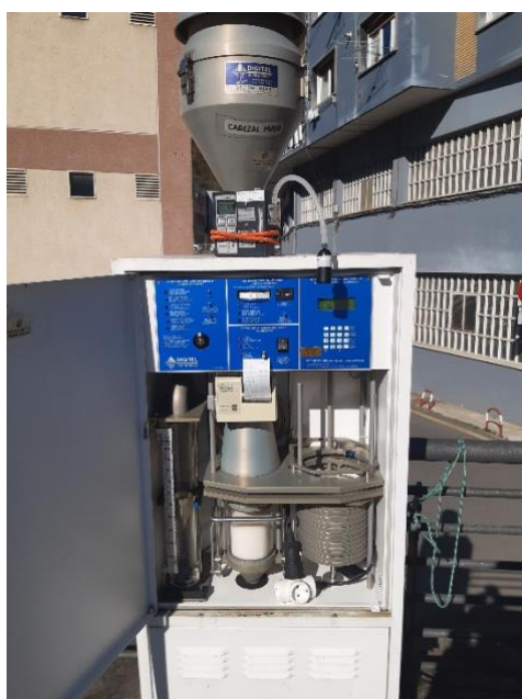
Figura 12: Equipo captador de partículas Digitel High Volume con filtros y puff. A la derecha el puff de poliuretano para captar el contaminante.
