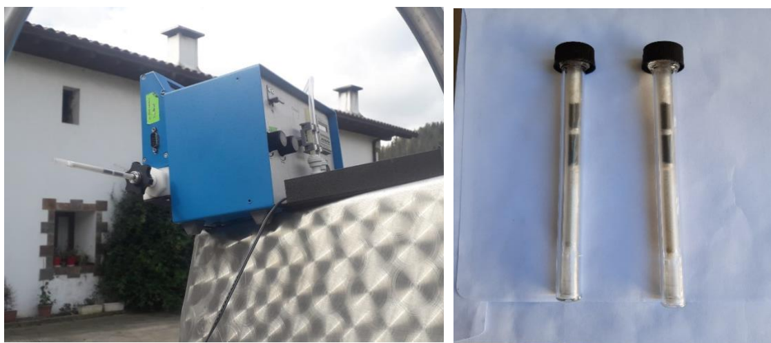
FIGURA 5: BOMBA Y TUBOS COMBINADOS PARA EL MUESTREO MANUAL DE COVs
