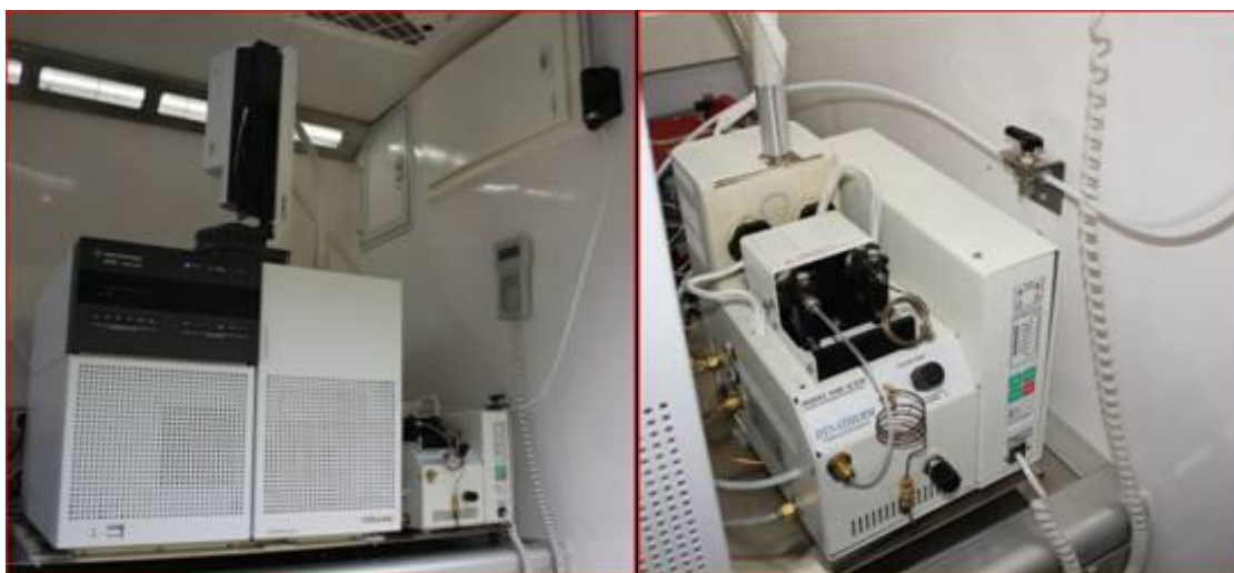
FIGURA6: EQUIPOS DE DESORCIÓN TÉRMICA ACEM9305 Y GC/MSD 5975T, DONDE SE OBSERVA EL DISPOSITIVO PARA CONTROL MANUAL (CENTRO DERECHA) Y EL MÁSTIL DE TOMA DE MUESTRA (DERECHA SUPERIOR), ASÍ COMO AMPLIACIÓN DEL EQUIPO ACEM9305 CON DETALLE DE LA VÁLVULA DE CONMUTACIÓN INDOOR/OUTDOOR.
