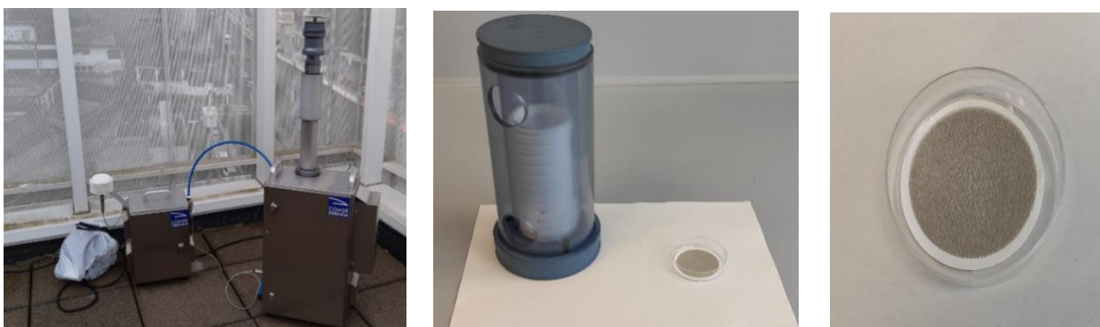
Figura 10: Equipo Derenda Centro Salud (Eibar), soporte de filtros y filtro para muestreo de partículas.
