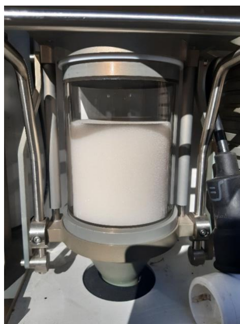
Figura 12: Equipo captador de partículas Digitel High Volume con filtros y puff. A la derecha el puff de poliuretano para captar el contaminante.
