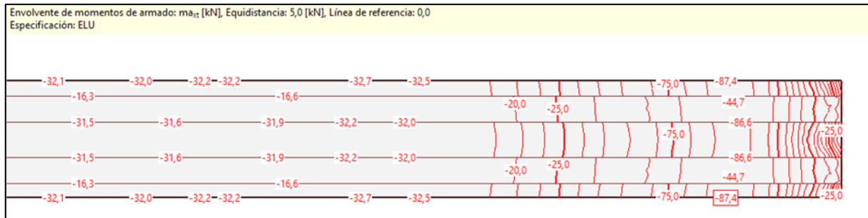
Figura 73. Momentos longitudinales armado cara superior. Losa 0,50 m.
