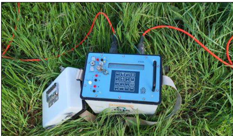
Figura 17. Equipo utilizado para SEV.
