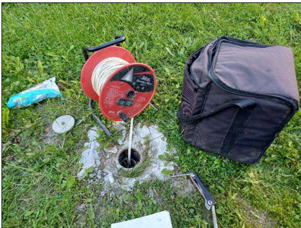
Figura 14. Medida del nivel freático en el sondeo S-2.
