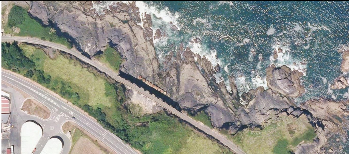
2012. Bloques de protección anclados al sustrato rocoso. Se mantiene la vegetación en la parte inferior de la ladera.
