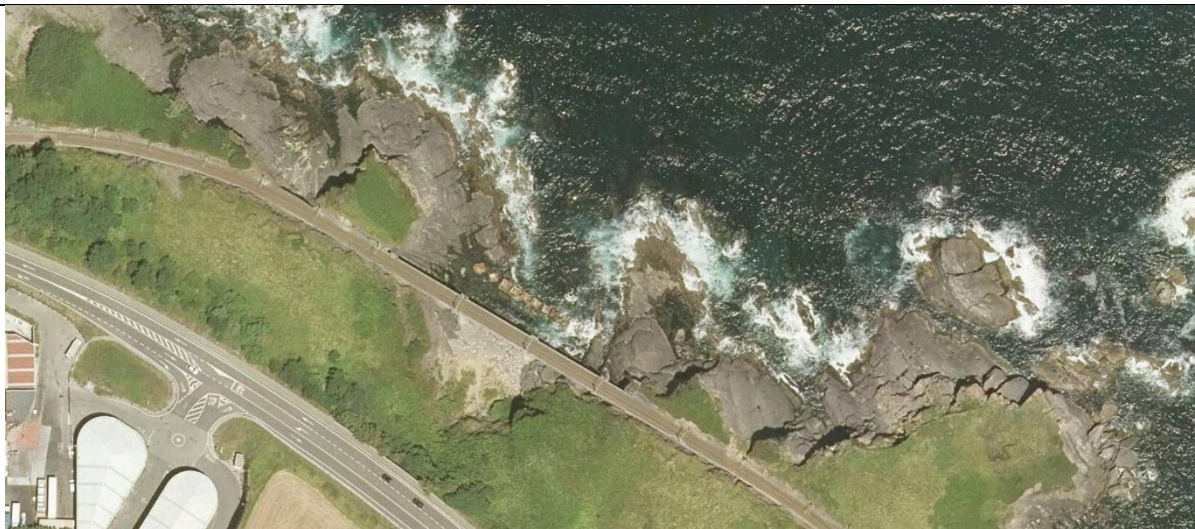
2016. Bloques de protección anclados al sustrato rocoso, pero con signos evidentes de deterioro. Se observa menor vegetación en la parte inferior de la ladera posiblemente causada por la incidencia de los temporales del año 2014.
