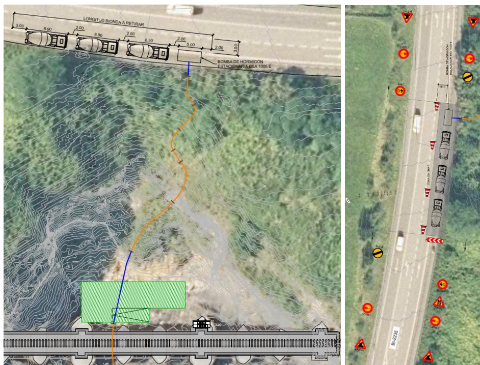
Tubo para hormigonado del dique y señalización BI-2235
