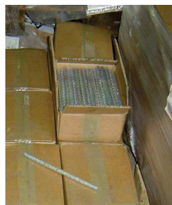
Fotografía de pasadores de anclaje entre mallas de refuerzo y placas de hormigón.
