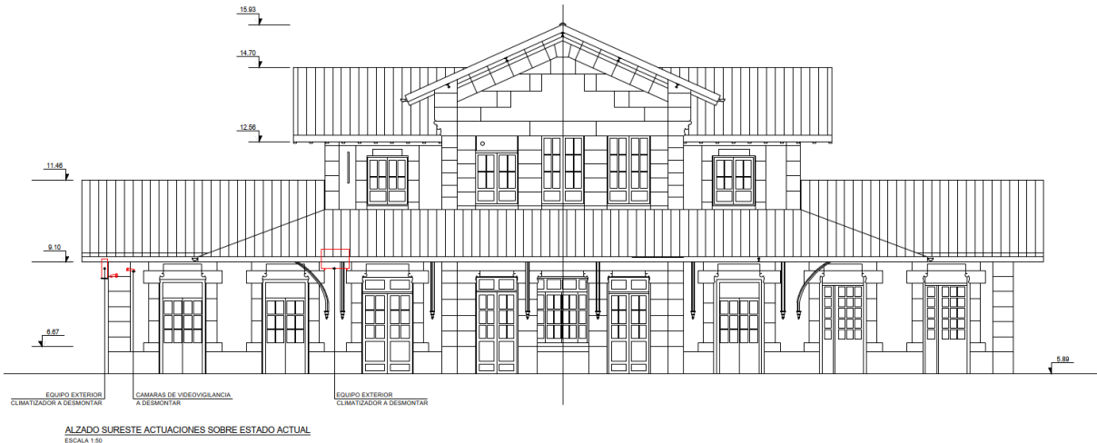
ALZADO SURESTE ACTUACIONES SOBRE ESTADO ACTUAL ESCALA 1:50
