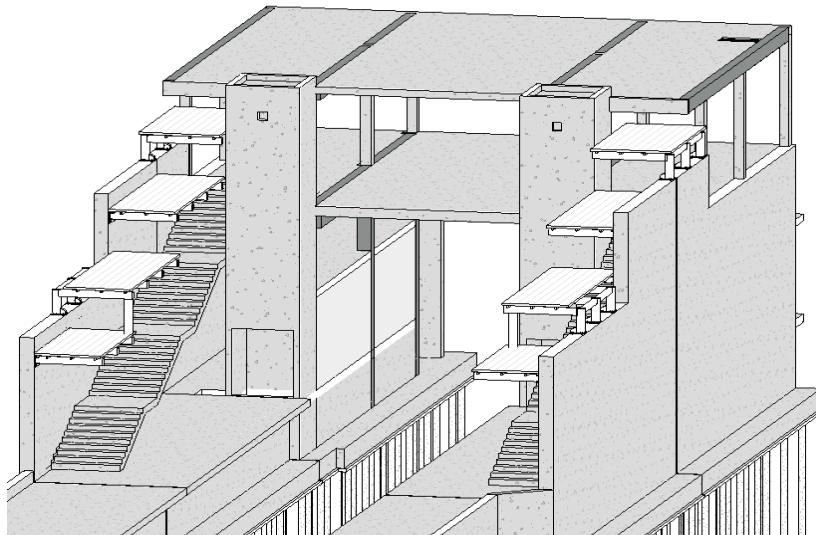
La planta baja del edificio, dividida en dos mitades por la vía, es una continuación de la misma sección de los andenes, compartiendo cimentación. Desde esta cimentación parten muros perimetrales de hormigón armado de 45cm de espesor que sirven como muros de carga para las plantas del edificio y como propio cerramiento del ámbito de vías de la estación con el espacio público.
