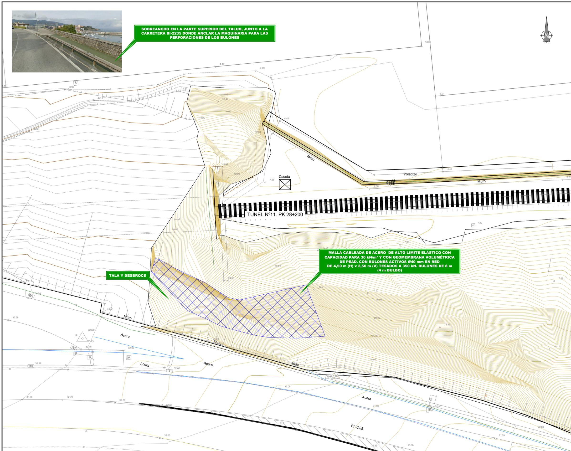
**MALLA CABLEADA DE ACERO DE ALTO LÍMITE ELÁSTICO CON CAPACIDAD PARA 30 kN/m<sup>2</sup> Y CON GEOMEMBRANA VOLUMÉTRICA DE PEAD. CON BULONES ACTIVOS Ø40 mm EN RED DE 4,50 m (H) x 2,50 m (V) TESADOS A 350 kN. BULONES DE 8 m (4 m BULBO)**
