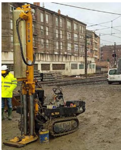
Figura 1 Ensayo de penetración dinámica llevado a cabo en campo
