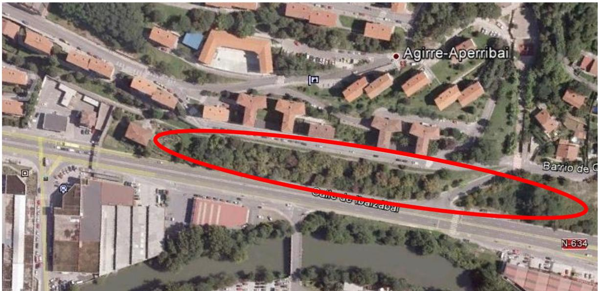
El escaso espacio disponible para la implantación de la Estación, unido a los múltiples condicionantes del entorno, obligan a construir una estación de planta irregular, enmarcada en un falso túnel que da cabida también a las ventilaciones de emergencia y ventilación EBA de la estación. Se trata de una estación de planta curva y andén central, siendo este de anchura variable a lo largo de la Estación.
