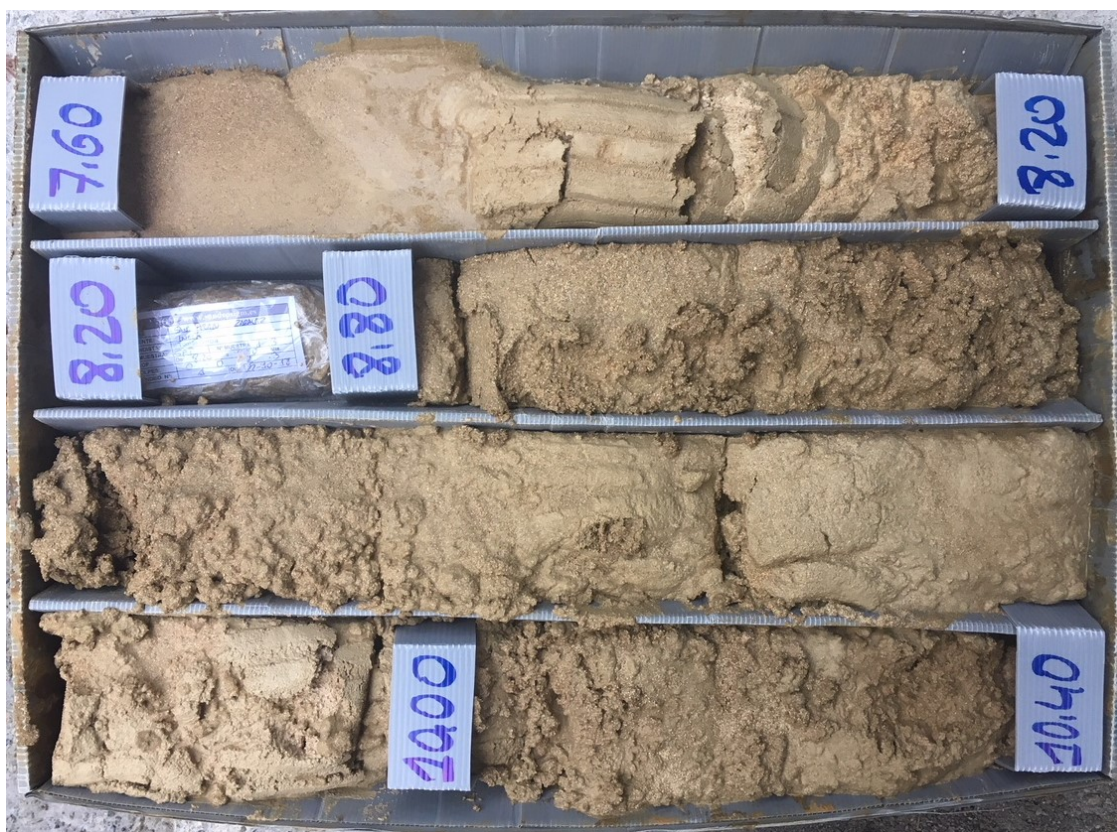
Nivel 3, depósitos someros formados por arena con algo de grava e indicios de finos. Registro del sondeo S-1 caja 4 (7,60-10,40 m).
