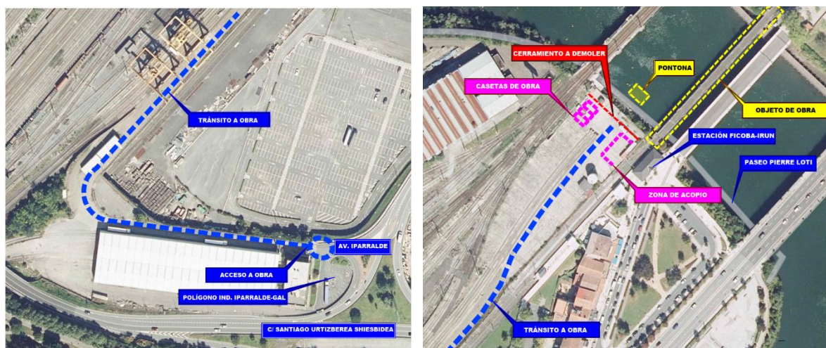
Figura 15. Acceso por terminal de contenedores
