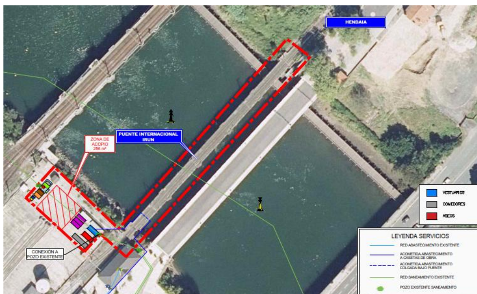
Figura 49. Instalaciones de obra
