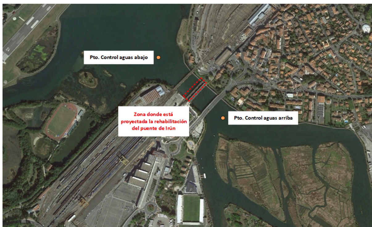
Figura 9. Puntos de control donde se ha analizado la variación de nivel, velocidad, salinidad y transporte potencial, situados aguas arriba y aguas abajo de la actuación proyectada en la ría del Bidasoa.
