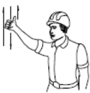
10 BAJAR EL AGUILÓN O PLUMA Y LEVANTAR LA CARGA
