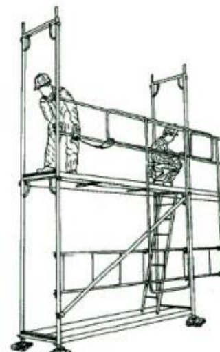
Montaje del resto del andamio
