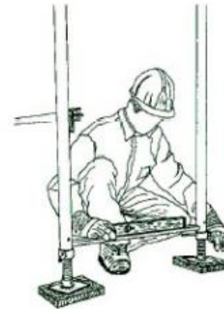
Comprobación de la nivelación horizontal
