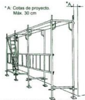
Encadenado del andamio y comprobación de la separación del muro
