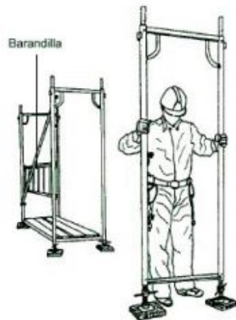
Colocación de las barandillas y posicionamiento del siguiente suplemento
