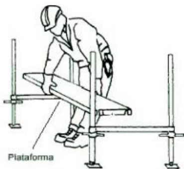
Colocación de la plataforma en los soportes de iniciación
