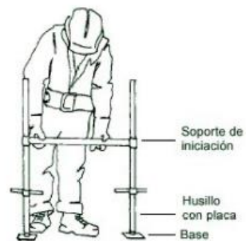
Introducción del soporte de iniciación en los husillos con placa
