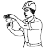
11 GIRAR EL AGUILÓN EN LA DIRECCIÓN INDICADA POR EL DEDO
