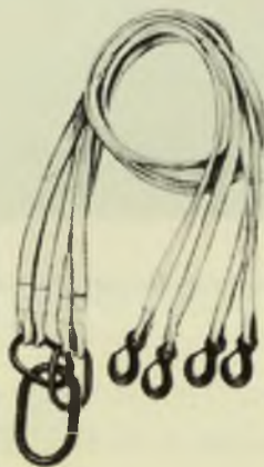
Fig. 31. Eslingas de poliéster con ganchos de seguridad para el izado de blindajes de aluminio
