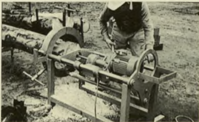
Fig. 17. Máquina para hacer cavidades a los troncos y alojar las cabezas de los codales
