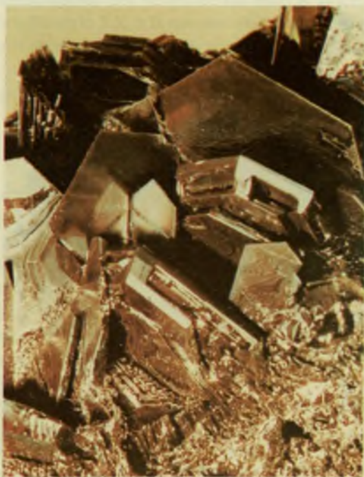
Fig. 46.—Oxido de aluminio en forma de cristales.
