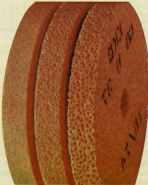
Muelas indicando el tipo de estructura abierta, media y cerrada.
