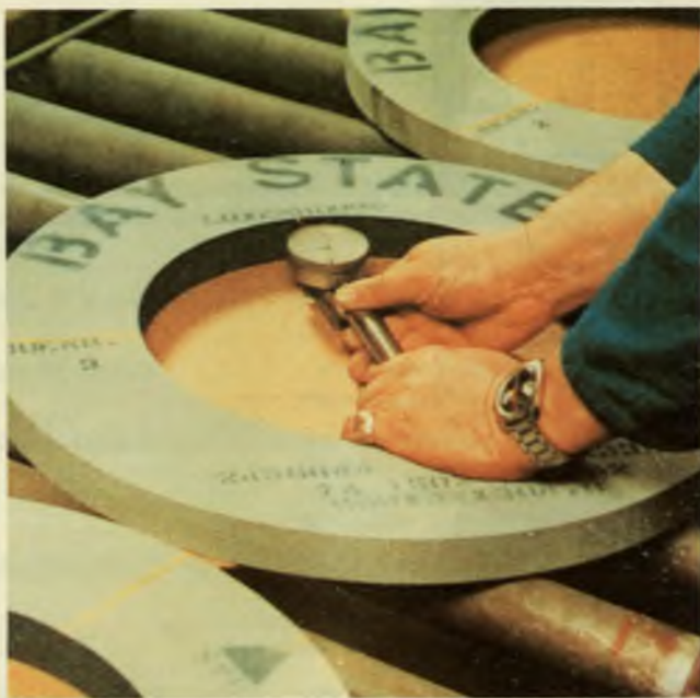
Verificación geométrica de las dimensiones de la muela.
