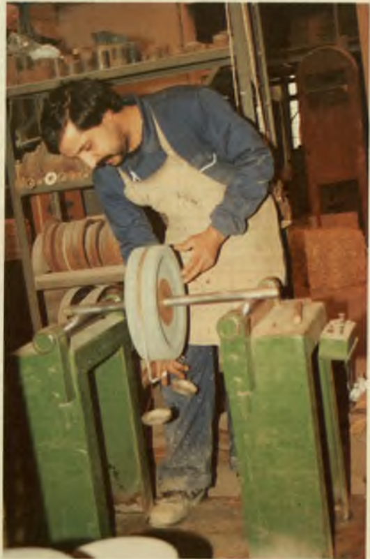
Fig. 21.— Forma de equilibrado estático
