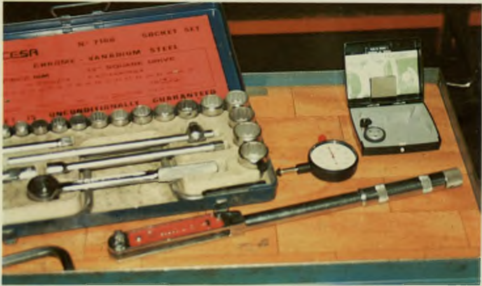
Aparato para control de las r.p.m. y llave dinamométrica con sus adaptadores.
