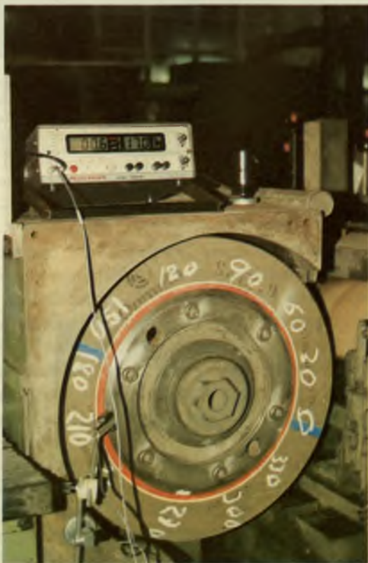
Fig. 30.—Equilibrado en dos planos. Integración de la brida en rectificadoras sin centros.
