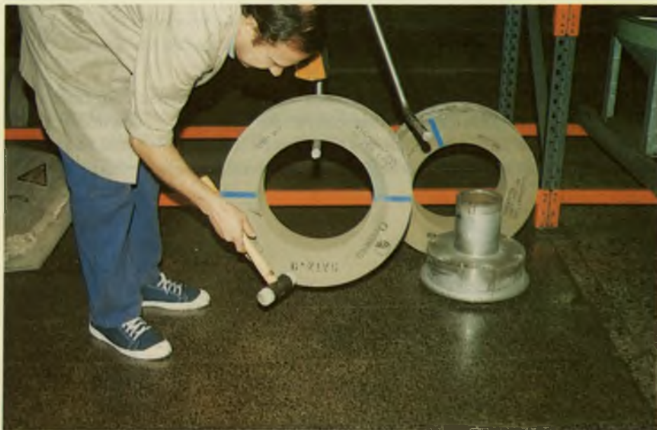
Comprobación de posibles defectos por ensayo del sonido
