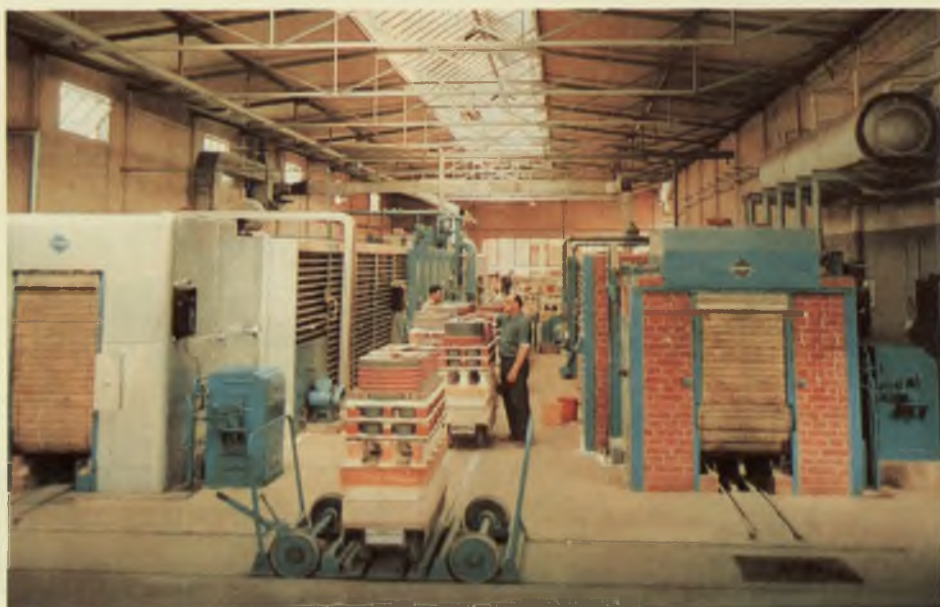
Carros cargados de muelas para realizar el secado y recocido en los hornos.
