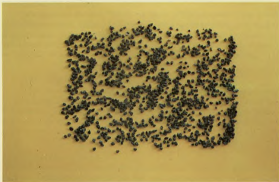
Corindón normal. Oxido de aluminio cristalizado 95% de pureza. Tamaño de grano n.º 10.
