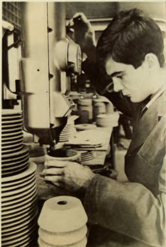
Prueba durante el control de velocidad de la muela.
