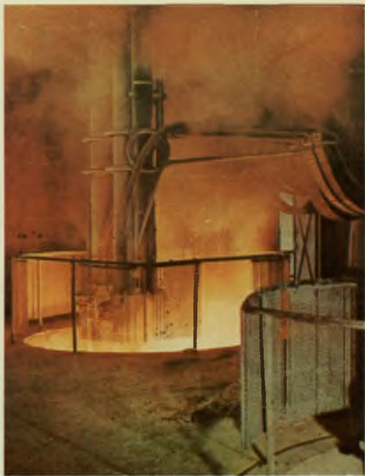
Fig. 45.—Horno de fusión de la bauxita.
