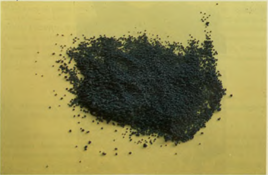
Fig. 48.—Masa de corindón normal vitrificado.
