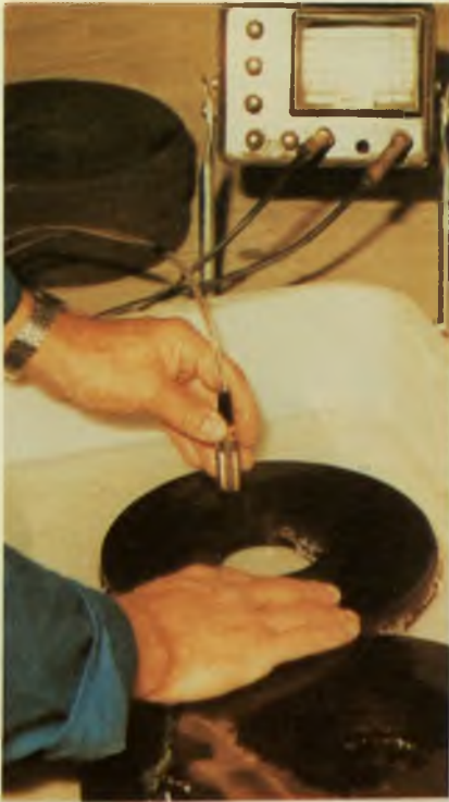
Control de defectos de muelas por ultrasonidos.
