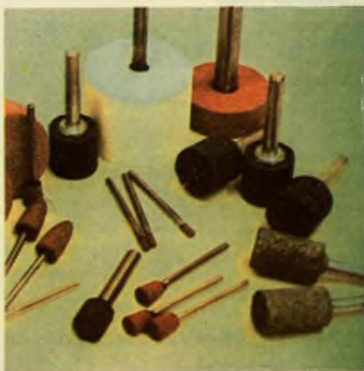
Muelas para interiores y de vástago.
