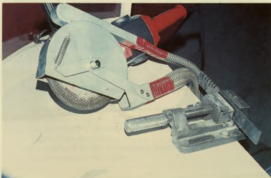
Fig. 52.—Esmeril portátil con aspiración localizada.
