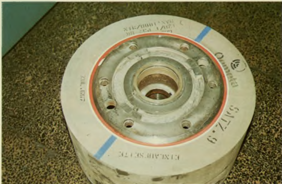
Inicio del montaje de la muela.
