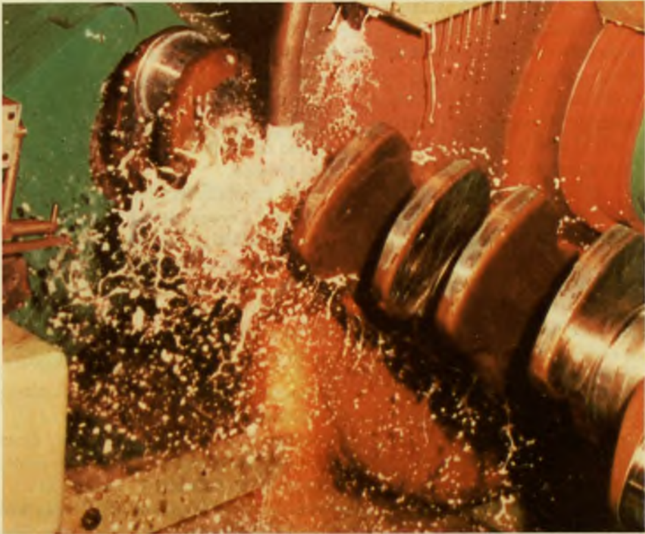
Fig. 55.—Rectificado de un cigüeñal. Uso de fluidos de corte.
