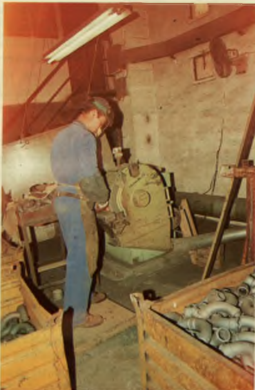
Fig. 50.—Esmerilado normal a pulso. La esmeriladora dispone de aspiración localizada.
