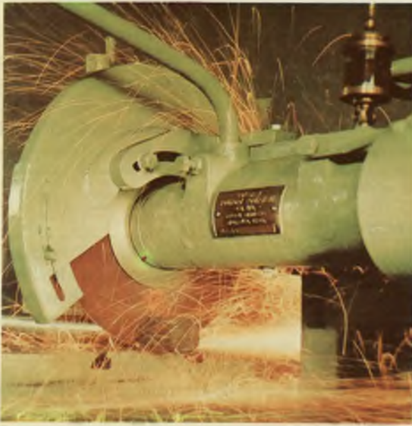
Fig. 49.—Tronzadora de disco abrasivo trabajando sin refrigeración.
