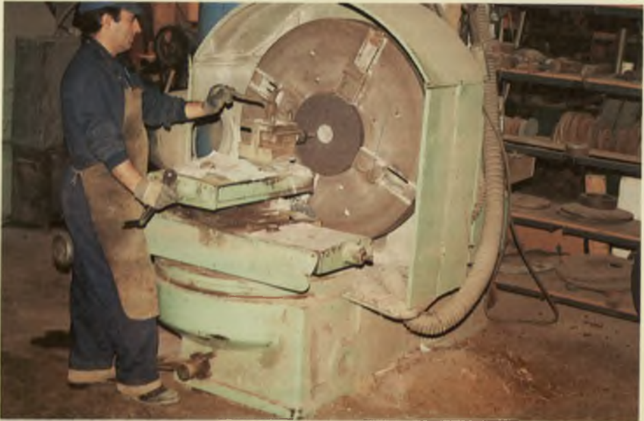
Fig. 41.—Reavivado y conformado de una muela.
