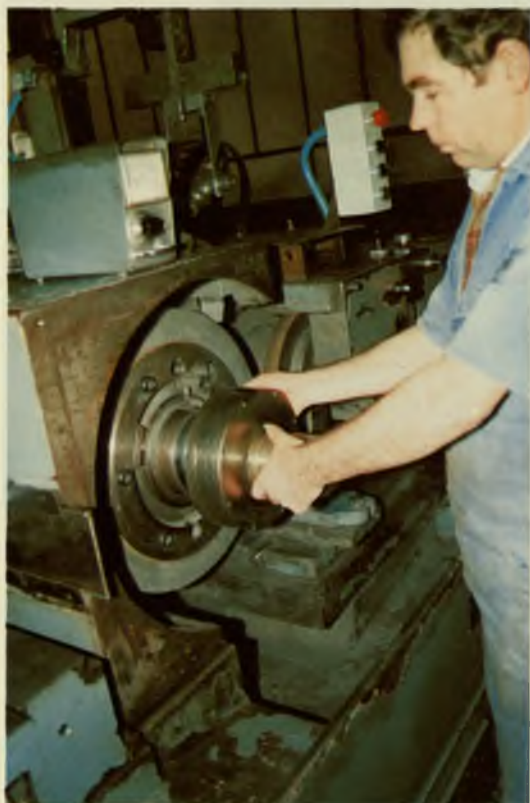
Fig. 34.—Equilibrado sobre el eje portamuelas.
