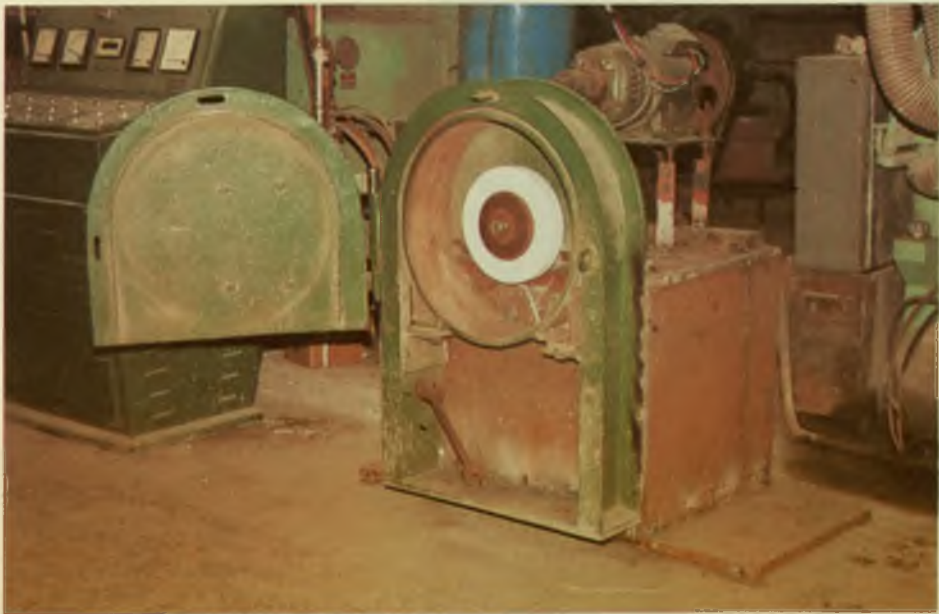
Muela dispuesta para el control de la velocidad útil y de rotura.
