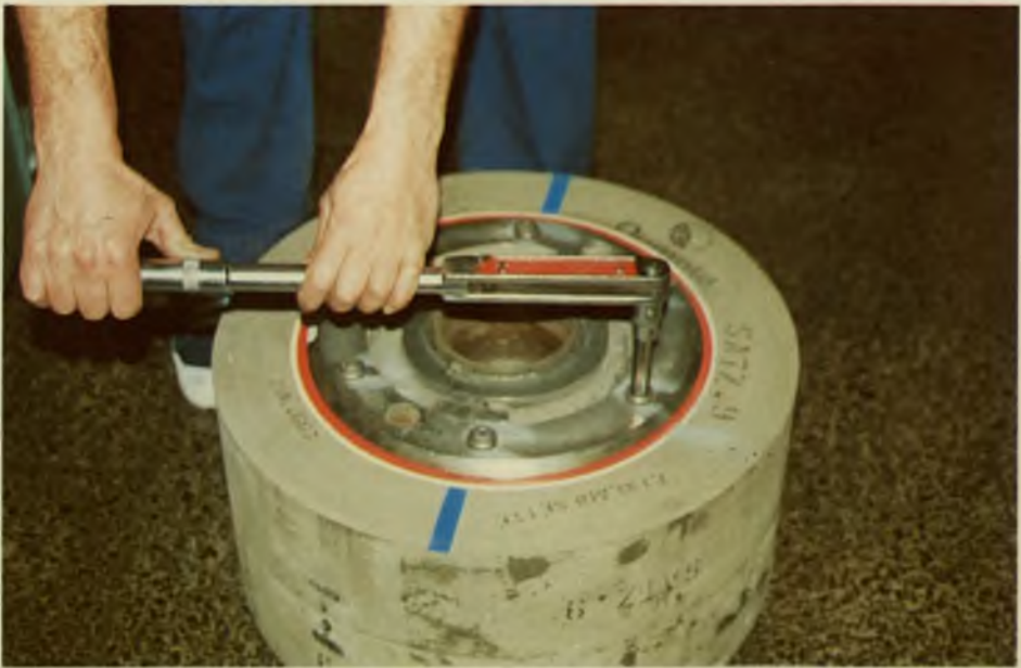
Apriete con llave dinamométrica.
