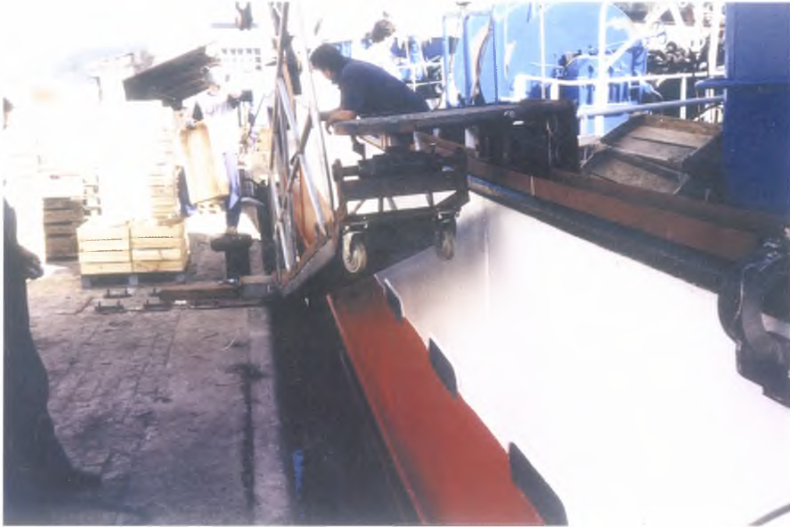
Kaiari nola lotzen zaion eta arrantza-ontziaren kareleko erroadura-bidea erakusten dituen irudia.
