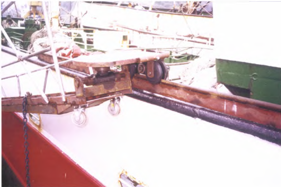
Pasabidearen goiko zatiaren irudia. Ontziaren karelean instalatuta dago eta erroaduraren bidea ikusten da.
