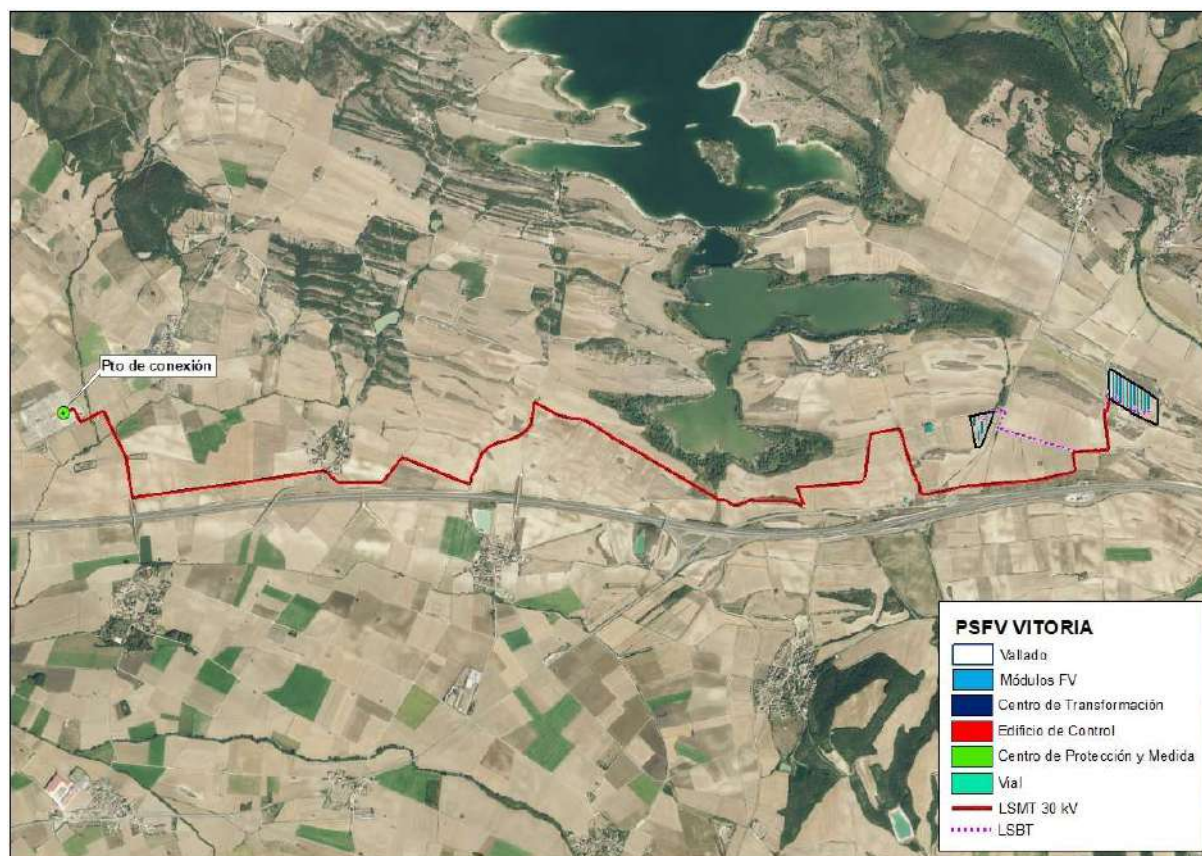
Imagen 2. Implantación de la PSFV Vitoria y sistema de evacuación seleccionado tras el estudio de alternativas
