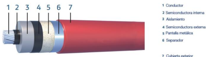
Figura 2. Detalle de cable de MT
