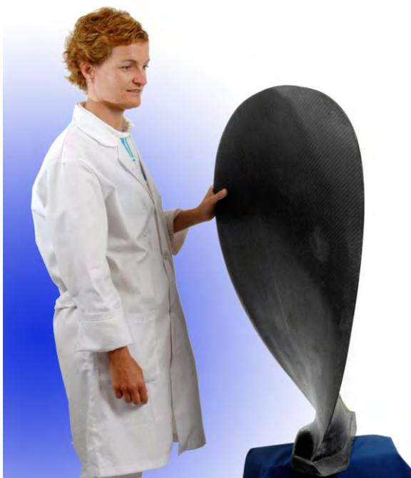
**Figura 7-1 Pala de material compuesto lista para el ensayo.**
