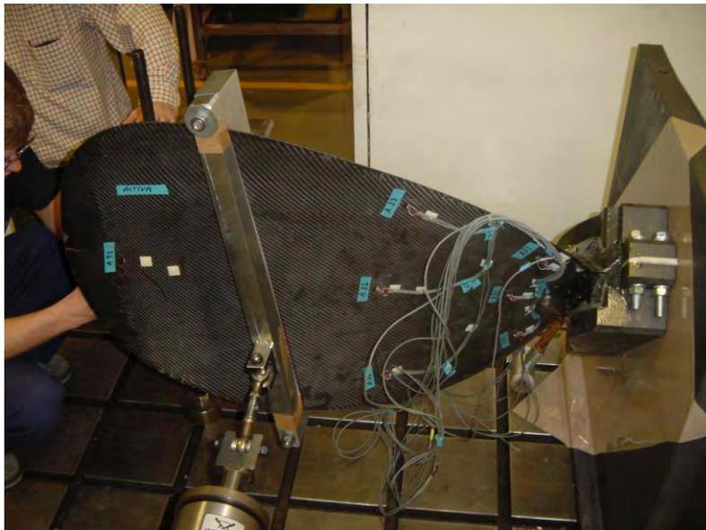
**Figura 7-7** extensímetros en cara activa y pasiva durante el ensayo.
