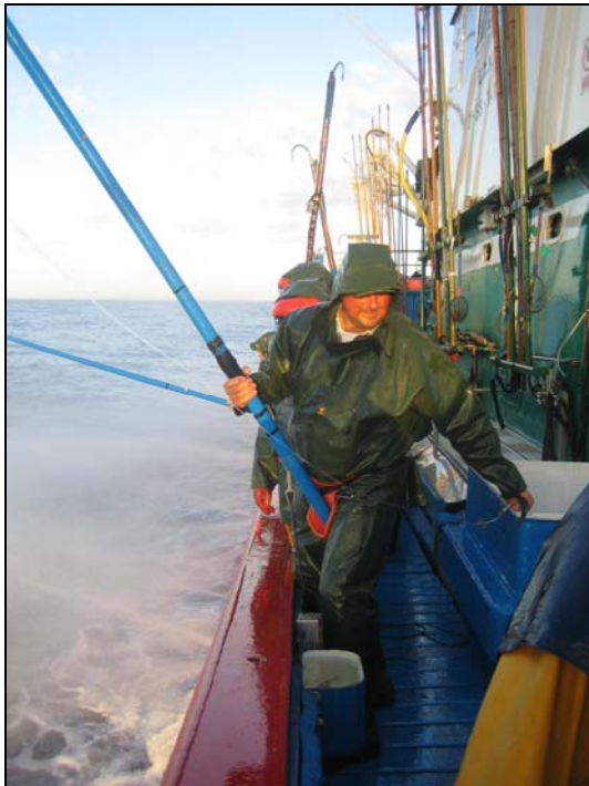
Imagen 32. Lanzamiento del aparejo con cebo mediante sistema tradicional (izada) y tiento del pescado con caña de control automático.
