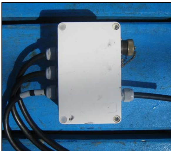
Imagen 27. Caja intermedia de conexionado.
