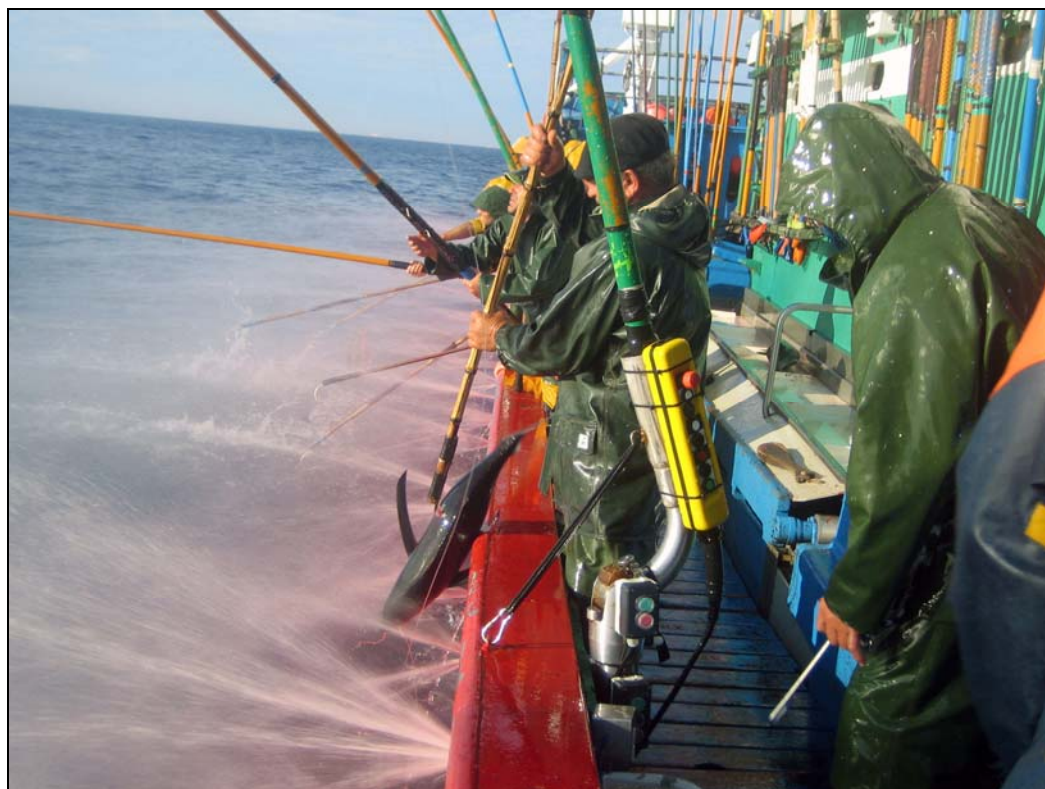
Imagen 41. Operativa de pesca con botonera implementada en el soporte y gancheo del pescado
