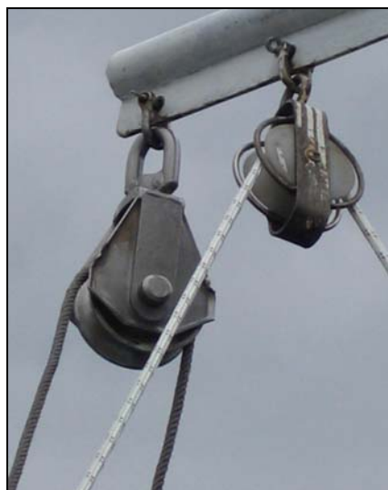
Imagen 29. Posición de izado de la caña (izda) y detalle de la polea con driza de acero
