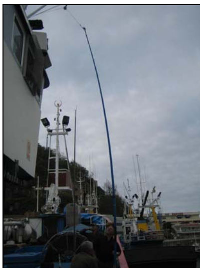
Imagen 29. Posición de izado de la caña (izda) y detalle de la polea con driza de acero
