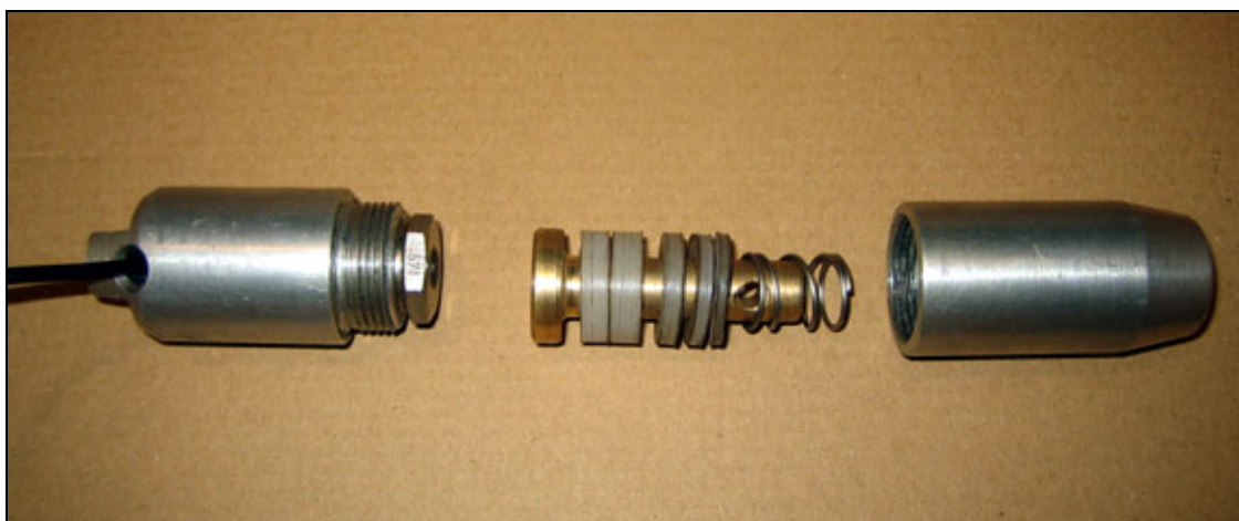
Imagen 34. Detalle del sensor de captura (rectificado).
