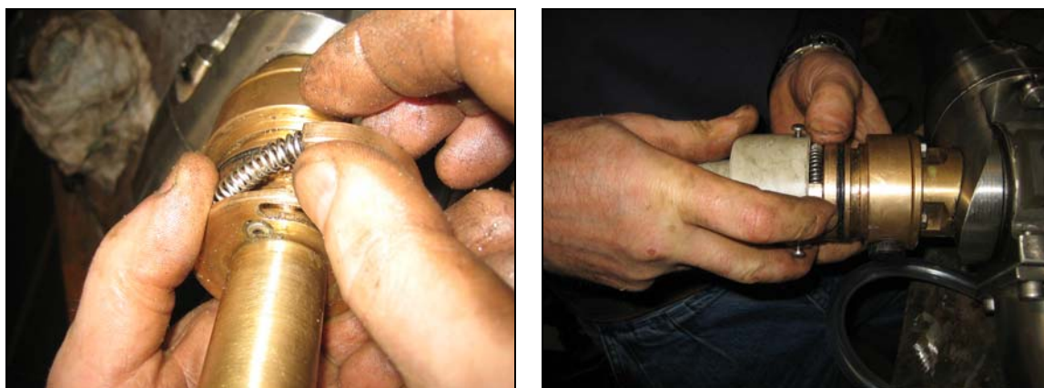
Imagen 21: Potenciómetro y su embutido con un casquillo de teflón (dcha).
