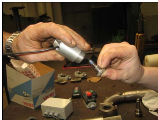
Imagen 33. Sensor de captura: disposición del sensor inductivo con racor.
