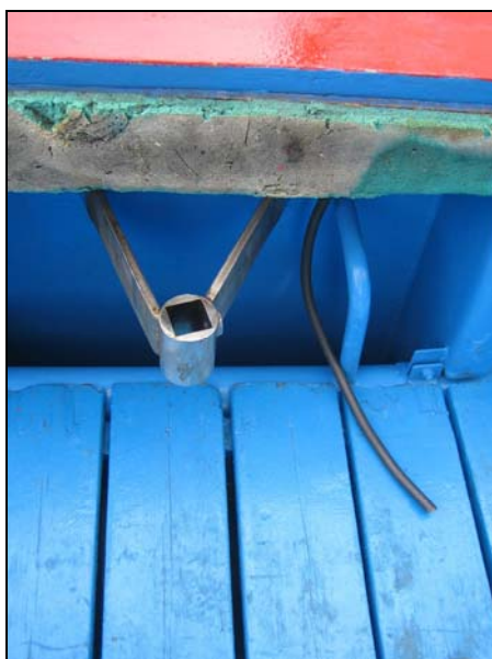
Imagen 13: Tintero (izda.) y fijación del soporte (dcha) sobre el costado interior de la banda de estribor.
