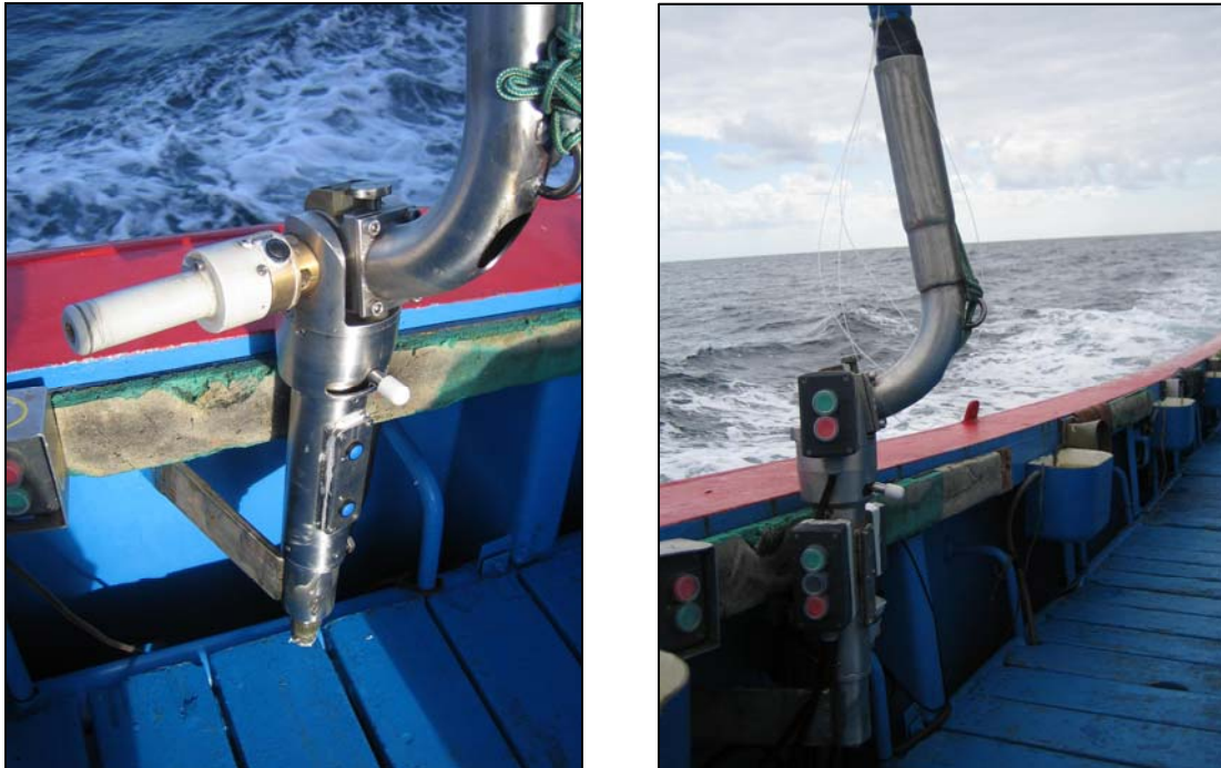
Imagen 28. Prototipo inicial (izda) con potenciómetro y prototipo con botoneras convencionales (dcha)
