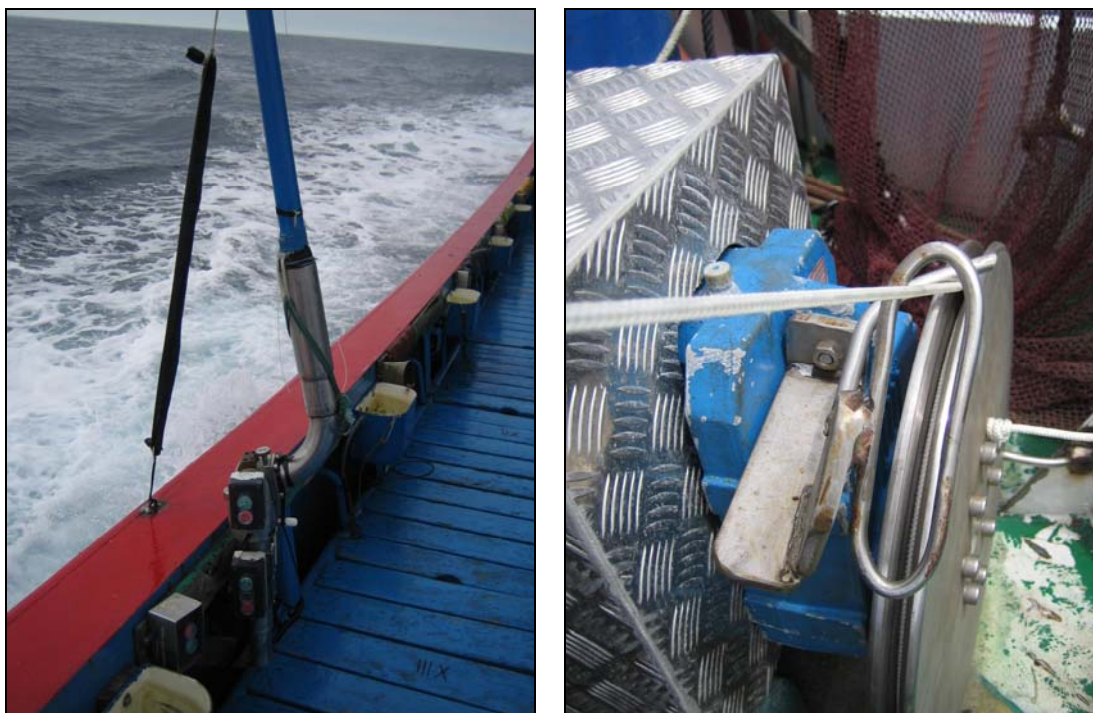
Imagen 30. Implementación de tensor de fortuna (izda) y carretel con driza de poliamida (dcha)
