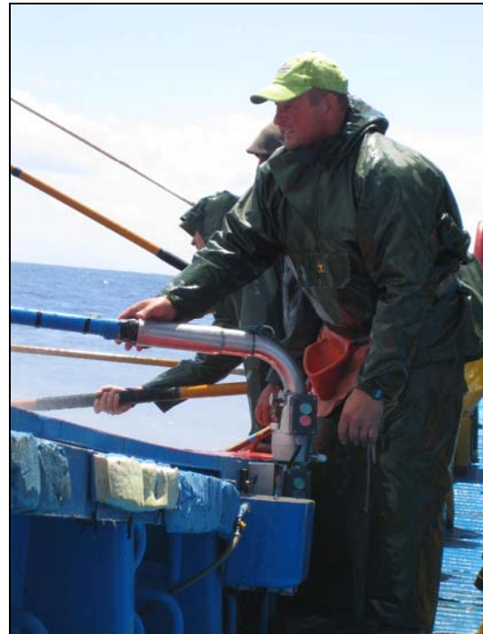
Imagen 32. Lanzamiento del aparejo con cebo mediante sistema tradicional (izada) y tiento del pescado con caña de control automático.
